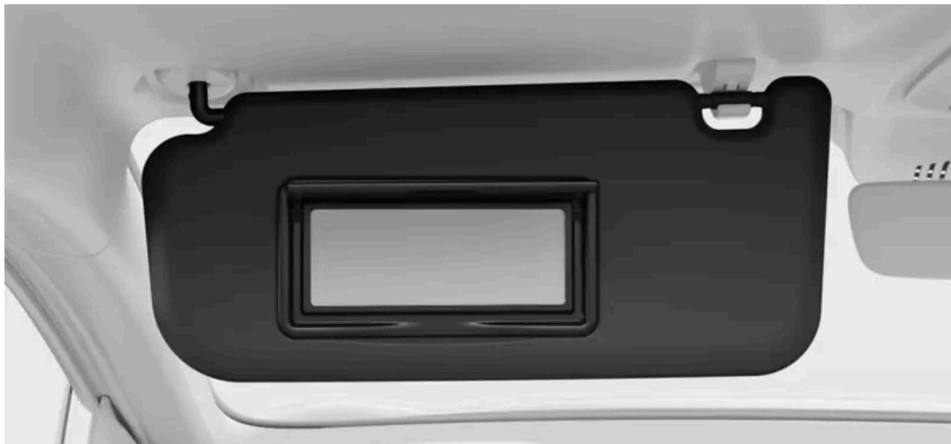
Puede desplegar las viseras y girarlas hacia un lado para que bloqueen la luz del sol procedente del lateral del automóvil.
