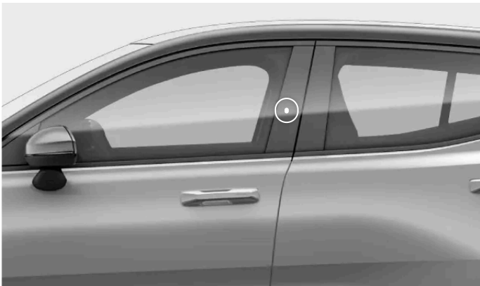
Ubicación del lector de llave en el montante de la puerta
