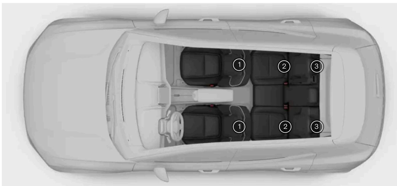
① Puntos de anclaje de sujeción inferior en los rieles del suelo de los asientos delanteros
