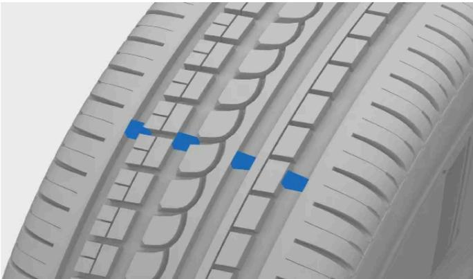
Las ranuras estrechas dispuestas a lo largo de la banda de rodadura del neumático son indicadores de desgaste. En el lateral del neumático figuran las letras TWI [1].
