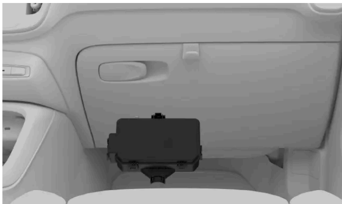
Ubicación de la caja de fusibles
