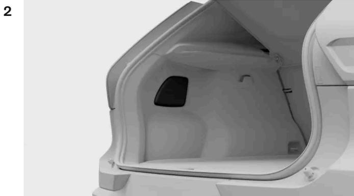
Presione el borde superior de la cubierta del panel para hacerlo pivotar y retirarlo.
