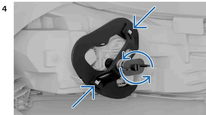
Desenrosque el tornillo de resorte girándolo en sentido contrario a las agujas del reloj. Deje el tornillo en el puente de apoyo para poder recuperarlo cuando lo necesite.
