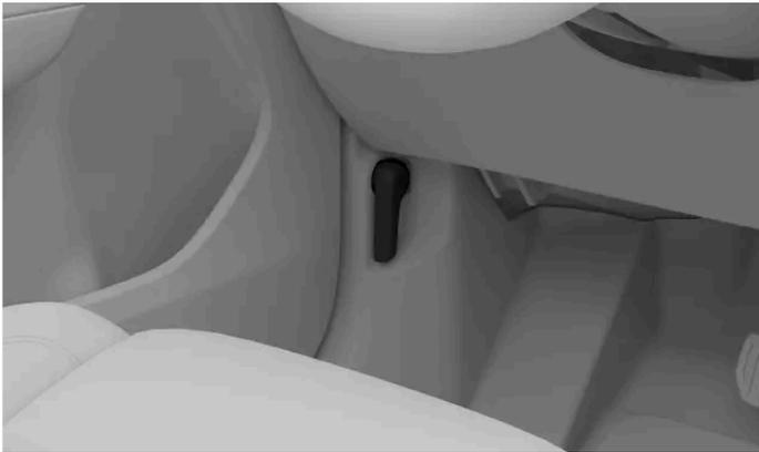
La primera palanca está debajo del salpicadero en el lado del conductor, justo delante de la bisagra de la puerta.
