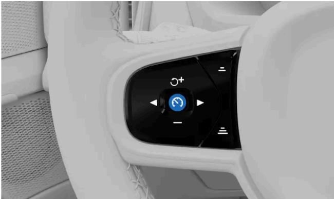
Cuando pueda hacerlo con seguridad, pulse el botón de Pilot Assist
