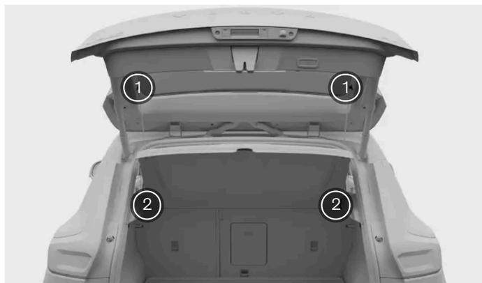
Hay dos puntos de fijación en la bandeja trasera y dos en la compuerta del maletero. Cuando la bandeja trasera está montada, unos cordones conectan la bandeja trasera con la compuerta del maletero.
