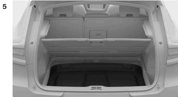
Coloque la bandeja trasera con la parte superior hacia abajo y la parte trasera hacia adelante.
