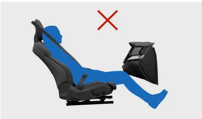
No incline el respaldo a una posición acostada. El cinturón de seguridad debe mantenerse tensado encima del hombro.
