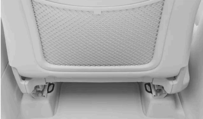
Los puntos de anclaje inferiores pueden localizarse detrás de las guías del suelo de los asientos delanteros.
