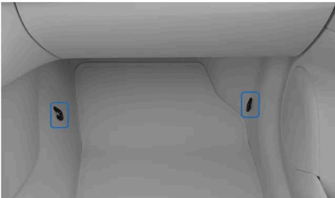
Los puntos de anclaje de sujeción inferior del asiento del acompañante delantero están situados a ambos lados de la zona para los pies del asiento.
