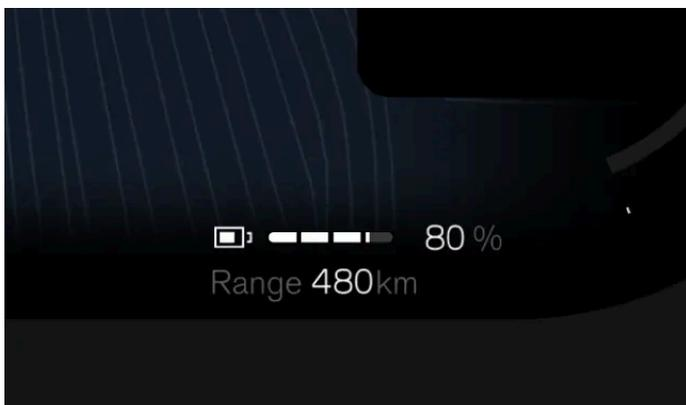
El indicador de la batería aparece en todo momento en la pantalla del conductor.
