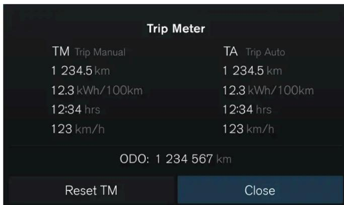
Su automóvil tiene cuentakilómetros parcial y cuentakilómetros. El cuentakilómetros parcial puede mostrar información sobre la distancia y el tiempo de conducción del automóvil, así como la velocidad de conducción media.
