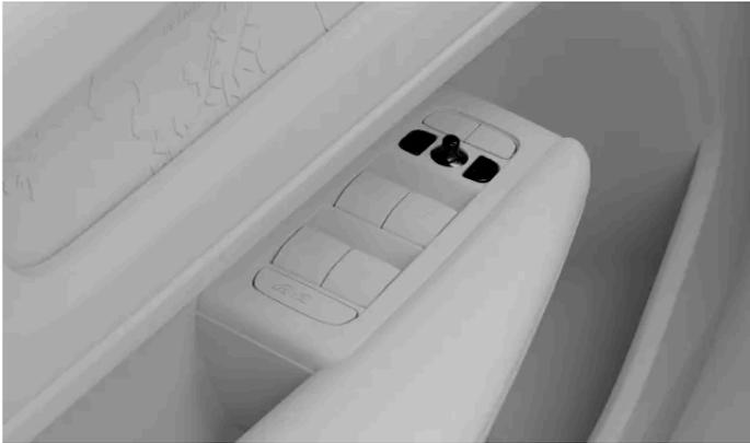
Controles para ajustar los retrovisores exteriores
