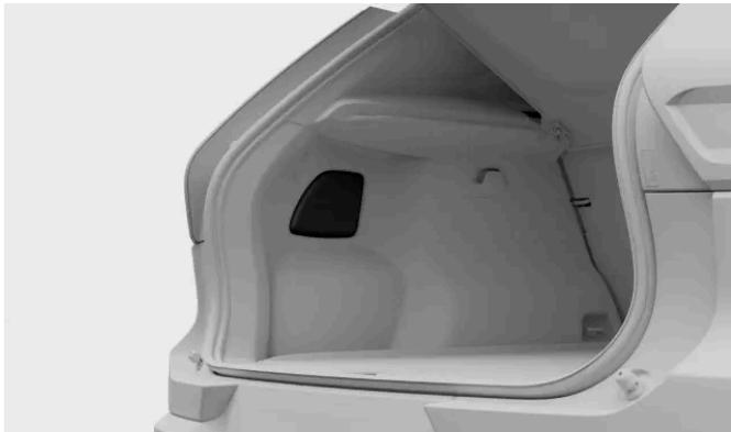
Presione el borde superior de la cubierta del panel para hacerlo pivotar y retirarlo.
