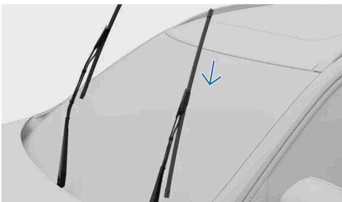
Compruebe que la escobilla del lado del conductor sea más larga que la del lado del acompañante. Deslice la escobilla en el brazo limpiaparabrisas. Asegúrese de que el pasador del brazo del limpiaparabrisas entra en el orificio de la escobilla. Introduzca la escobilla en el brazo del limpiaparabrisas hasta que escuche un clic.
