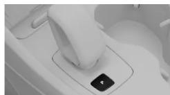
Accione manualmente el freno de estacionamiento pulsando el botón del freno de estacionamiento.
