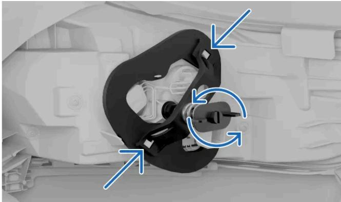
Desenrosque el tornillo de resorte girándolo en sentido contrario a las agujas del reloj. Deje el tornillo en el puente de apoyo para poder recuperarlo cuando lo necesite.
