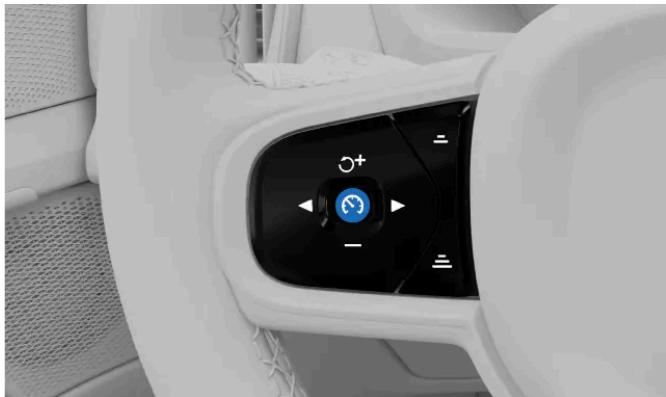
Cuando pueda hacerlo con seguridad, pulse el botón de Pilot Assist
