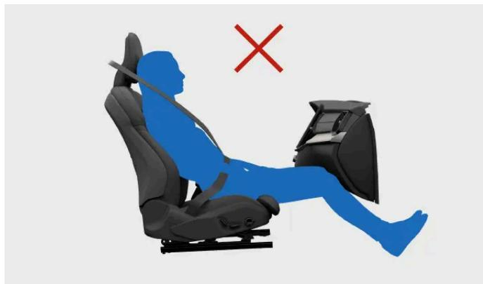
No se deslice hacia delante en el asiento. La zona lumbar debe estar en contacto con el respaldo.
