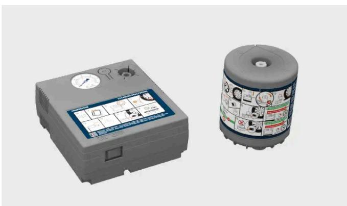
Su automóvil está equipado con un kit de reparación de neumáticos temporales que puede utilizarse para reparar pinchazos leves en un neumático.
