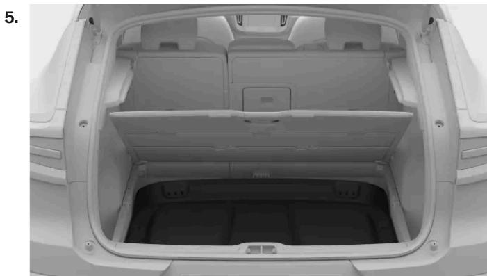
Coloque la bandeja trasera con la parte superior hacia abajo y la parte trasera hacia delante.
