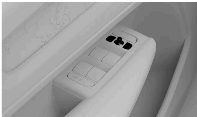
Controles para ajustar los retrovisores exteriores
