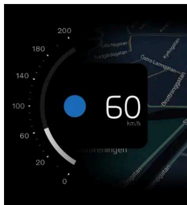
La forma en que aparecen las señales de tráfico a veces depende del modo seleccionado en la pantalla del conductor.
