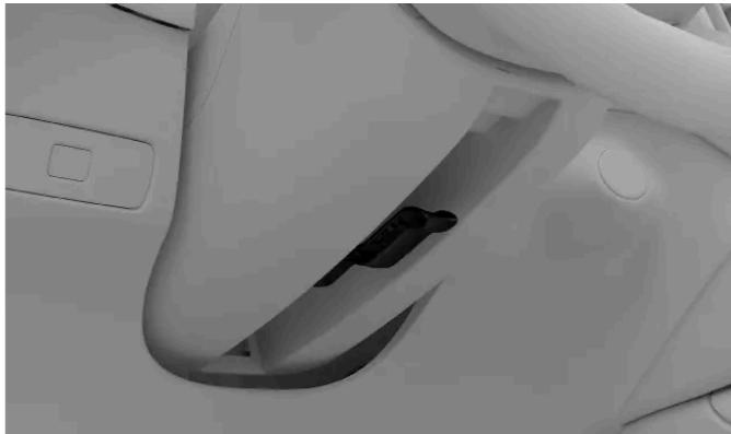
2. Sujete el volante y ajuste su posición.
