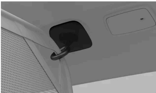
3. Sujete las esquinas inferiores de la red a los puntos de sujeción exteriores situados detrás de los asientos.
