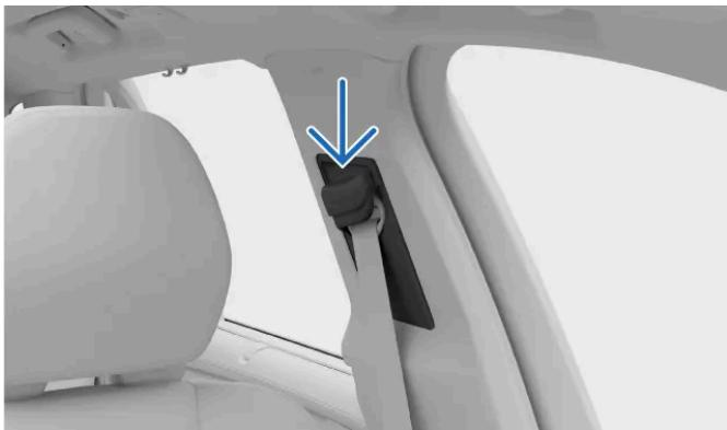
Punto de anclaje superior del cinturón de seguridad
