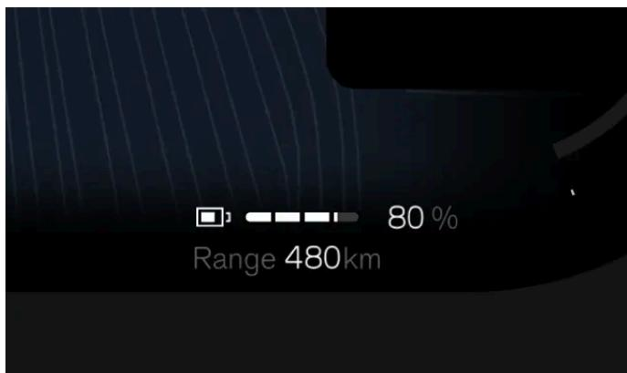
La autonomía depende sobre todo del nivel de batería del automóvil y los hábitos de conducción, pero las condiciones externas también pueden influir. El nivel de batería y la autonomía prevista aparecen en la pantalla del conductor. La autonomía prevista se calcula según su patrón de conducción, tanto actual como histórico.
