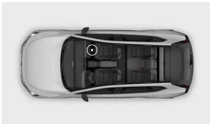
Ubicación del VIN en el travesaño debajo del asiento del acompañante
