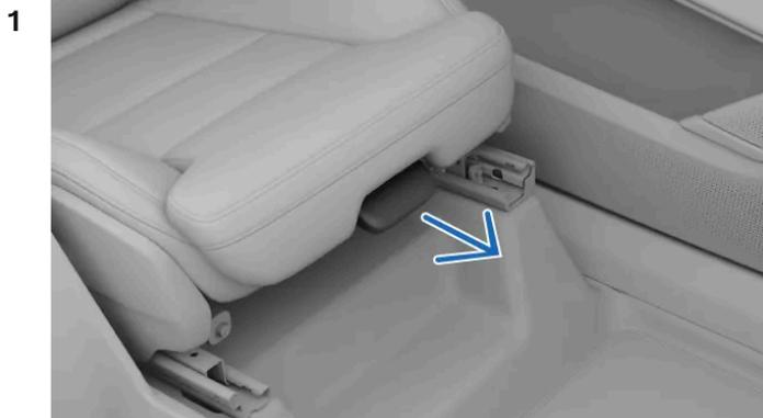
Sujete y tire del asa de la parte delantera del asiento.
