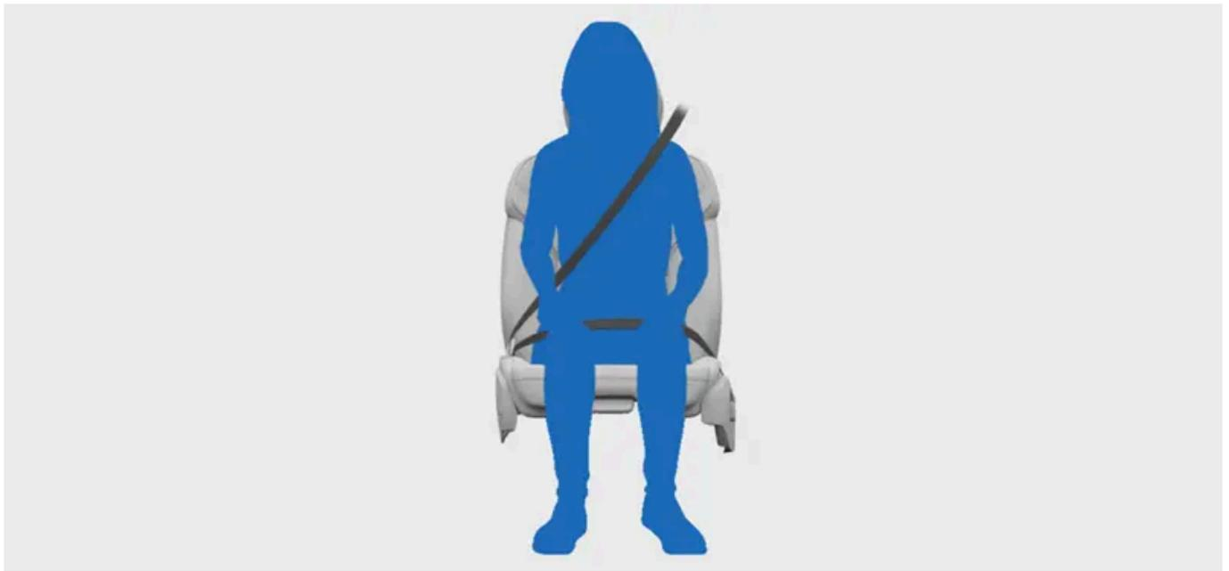
Cinturón de seguridad abrochado y ajustado correctamente.
