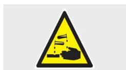
La batería contiene ácido corrosivo.
