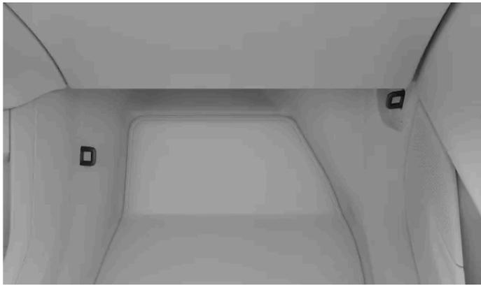
Con el accesorio de sujeción inferior delantero <sup>[1]</sup>, los puntos de anclaje del asiento del acompañante delantero están situados a ambos lados de la zona para los pies del asiento.
