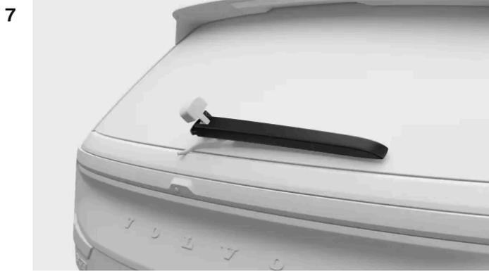
Repliegue el brazo del limpiaparabrisas de nuevo encima del parabrisas.
