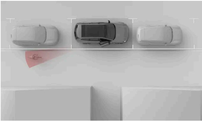
Las alertas de apertura de puertas están diseñadas para alertarle de la presencia de tráfico lateral, para evitar abrir una puerta en su trayectoria. Estas alertas pueden activarse con el automóvil parado o en movimiento muy lento <sup>[1]</sup>.
