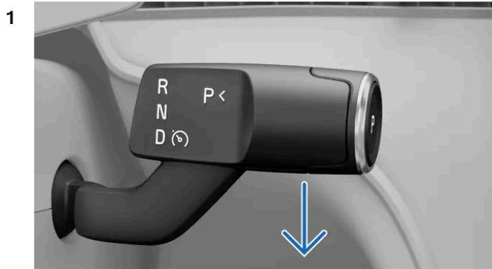
Cuando resulte necesario, mueva la palanca derecha del volante hacia abajo.
