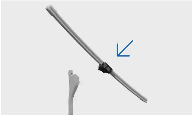
Compruebe que la escobilla del lado del conductor sea más larga que la del lado del acompañante. Sujetando la escobilla en posición horizontal, insértela en el brazo del limpiaparabrisas. Asegúrese de que el pasador del brazo del limpiaparabrisas entra en el orificio de la escobilla.
