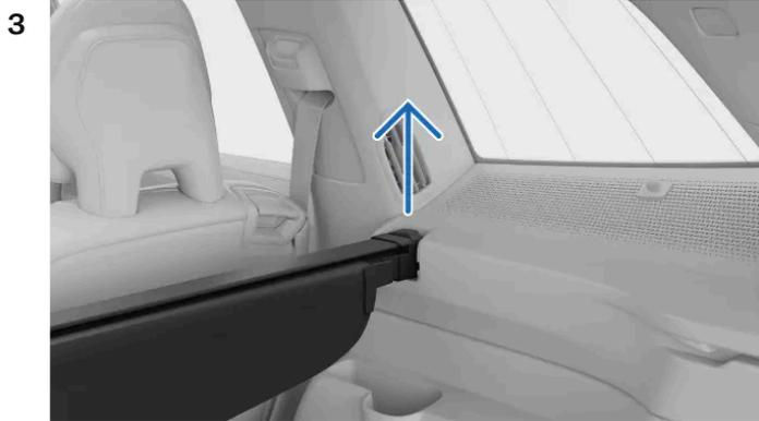
Saque completamente la cubierta de equipajes de las muescas en la parte trasera del maletero para retirarla.
