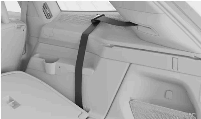
Aparte el cinturón de seguridad de la tercera fila cuando utilice la cubierta de equipajes. Retraiga el cinturón de seguridad y cuéguelo por la hebilla.
