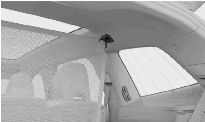
Introduzca cada pasador de la red de seguridad en los conectores de los laterales del interior del techo. Introduzca los pasadores hasta que encajen en su posición.
