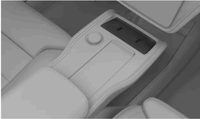
Posición del lector de tarjeta, utilizado para arrancar el automóvil con una tarjeta electrónica o una llave con funcionalidad remota descargada.
