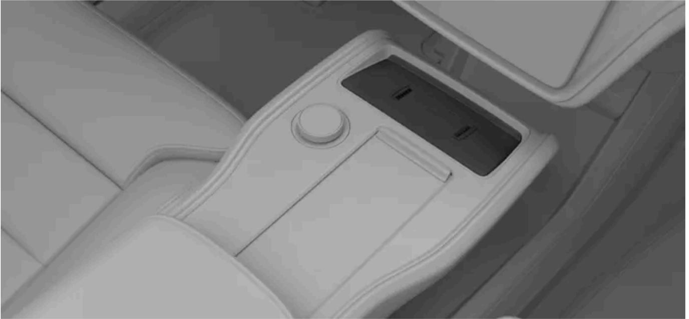
Para usar el cargador inalámbrico, su dispositivo debe tener la certificación de cumplimiento de la norma de carga inalámbrica Qi. Compruebe también que la carga inalámbrica esté activada tanto en el dispositivo <sup>[1]</sup> como en el cargador. Puede activar el cargador en la pantalla central.
