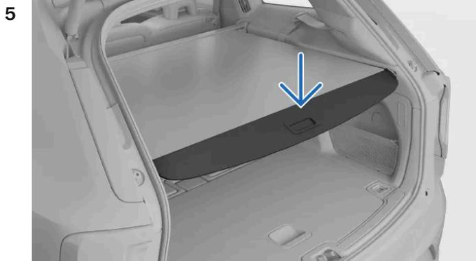
Incline el borde exterior de la cubierta de equipajes hacia abajo hasta que se bloquee en las ranuras.
