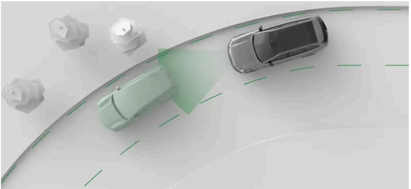
Pilot Assist puede facilitar la conducción de diferentes formas. Al utilizar Pilot Assist, debe seleccionar la velocidad objetivo. A continuación, el automóvil gestiona la aceleración y el frenado para cumplir con este objetivo y adaptarse al tráfico.
