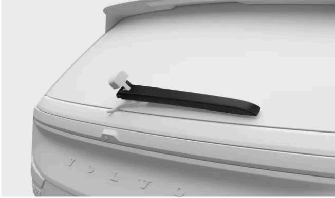
Repliegue el brazo del limpiaparabrisas de nuevo encima del parabrisas.
