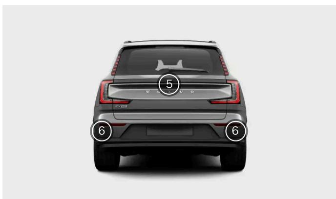
5 Hay una cámara de visión posterior en la parte central trasera del automóvil.
