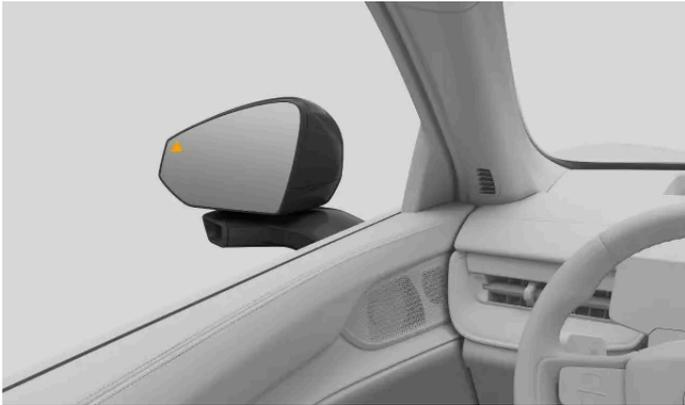
Cuando el automóvil detecta tráfico que se aproxima a sus laterales, aparece una luz en el retrovisor exterior. Si empieza a abrir la puerta en el lado en el que se ha detectado tráfico, la alerta se intensifica. Puede sonar una alerta acústica junto con las alertas visuales, en función de la urgencia de la advertencia.
