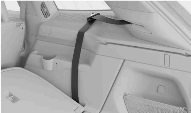
Aparte el cinturón de seguridad de la tercera fila cuando utilice la cubierta de equipajes. Retraiga el cinturón de seguridad y cuélguelo por la hebilla.
