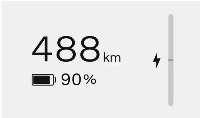
La autonomía depende sobre todo del nivel de batería del automóvil y los hábitos de conducción, pero las condiciones externas también pueden influir. El nivel de batería y la autonomía prevista aparecen en la pantalla del conductor. La autonomía prevista se calcula según su patrón de conducción, tanto actual como histórico.
