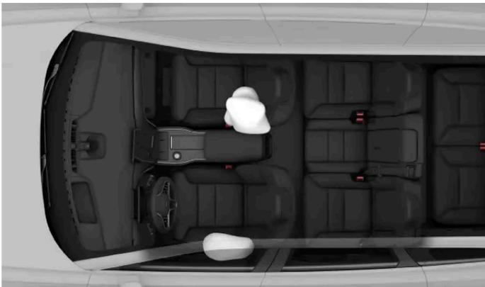
Airbags de colisión lateral izquierda para los ocupantes delanteros. En una colisión por el lado derecho, se despliegan en el lado opuesto de los asientos delanteros, en comparación con lo reflejado en el caso ilustrado.
