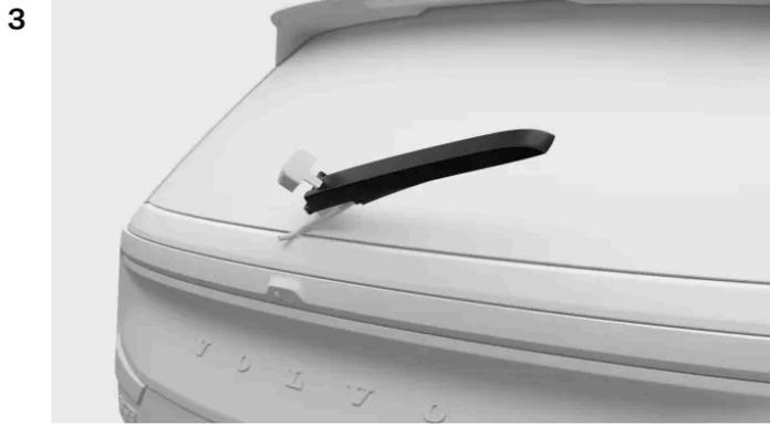
Agarre la parte central del brazo del limpiaparabrisas, elévelo y aléjelo del parabrisas trasero. Puede que detecte un poco de resistencia a medio camino, es la posición de bloqueo. Debe tirar del brazo y pasar de esa posición de bloqueo para que no vuelva a caer encima del parabrisas.
