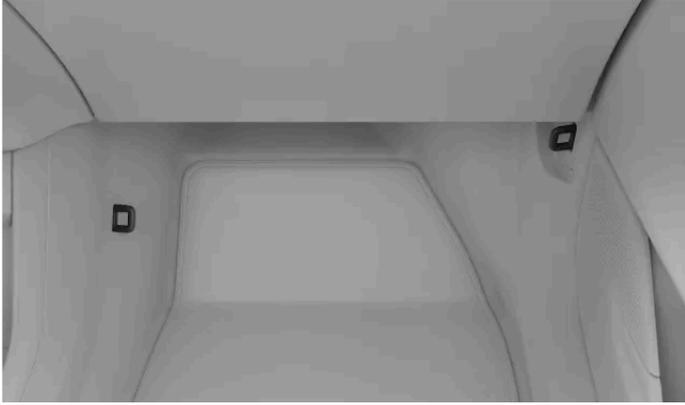
Con el accesorio de sujeción inferior delantero <sup>[1]</sup>, los puntos de anclaje del asiento del acompañante delantero están situados a ambos lados de la zona para los pies del asiento.
