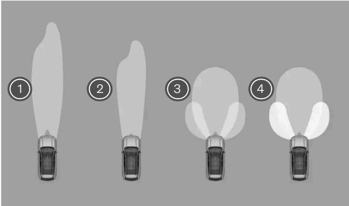
Las luces de cruce tienen cuatro tipos de haz automáticos
