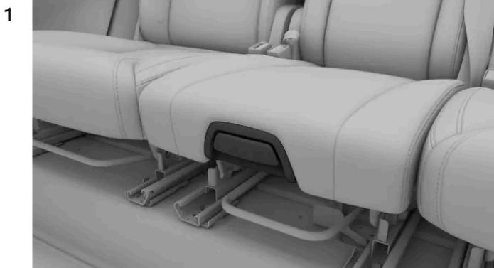
Tire del tirador en la parte delantera del cojín del asiento central para desbloquearlo.
