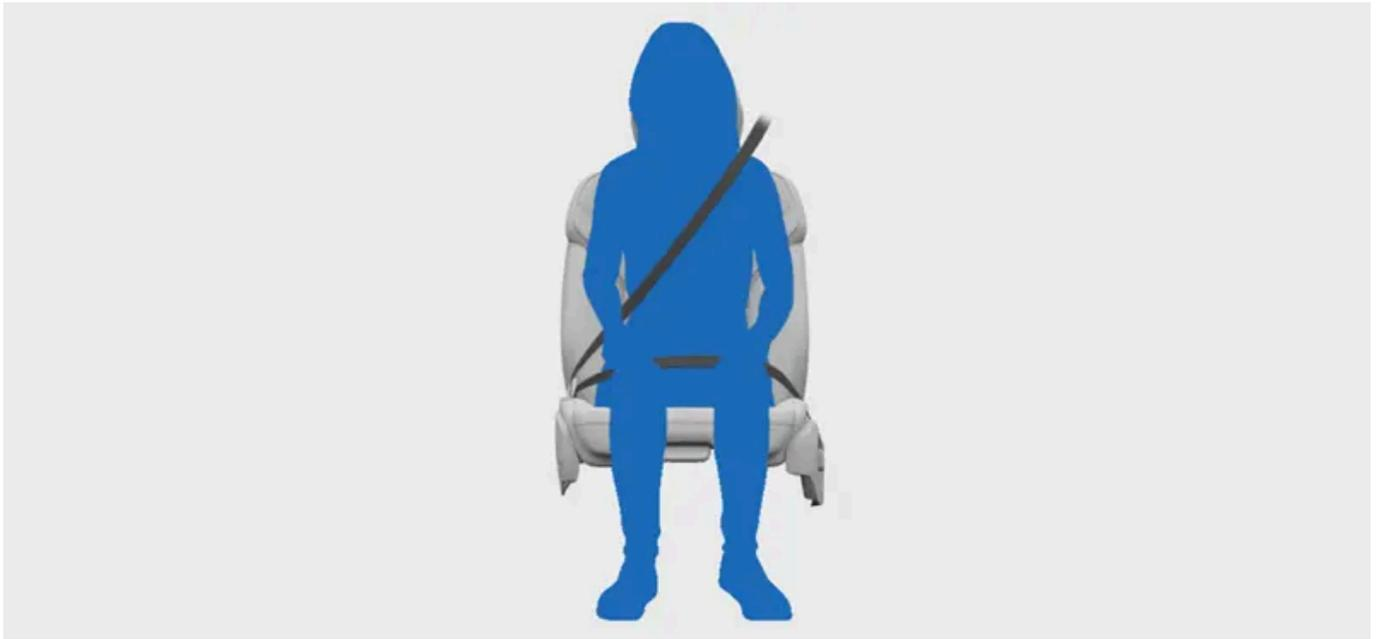
Cinturón de seguridad abrochado y ajustado correctamente.
