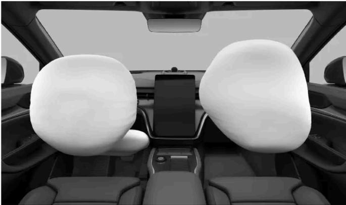
El lado de conducción tiene dos airbags delanteros. El airbag superior está dentro del volante y el airbag de rodilla está detrás de un panel debajo del volante.
