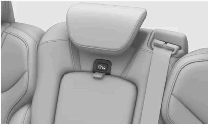
Botón de bloqueo en el reposacabezas central
