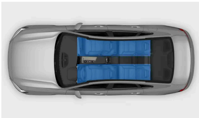
Zonas de climatización
