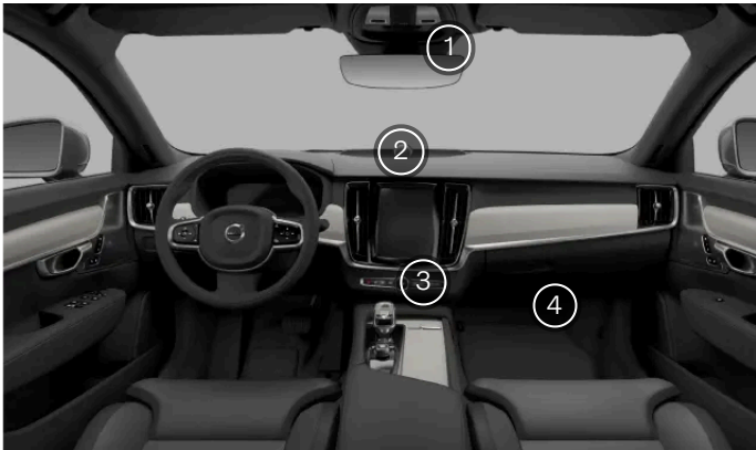
Los sensores de climatización interiores
