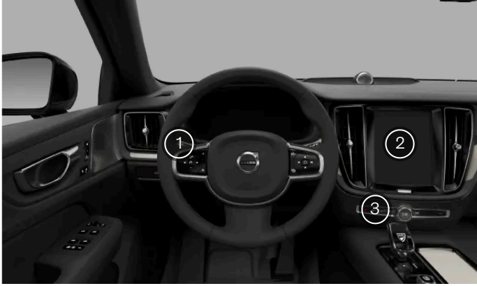
Posiciones de controles de luces exteriores
