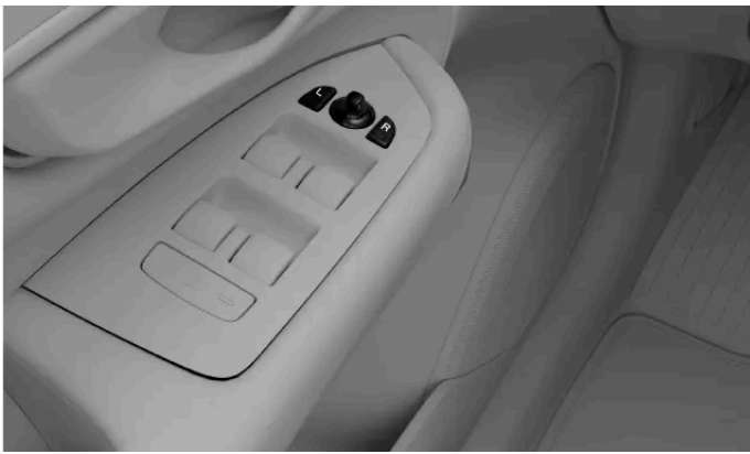
Controles para ajustar los retrovisores exteriores
