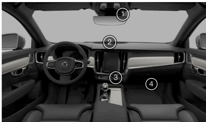
Los sensores de climatización interiores
