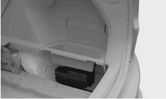
Ubicación de la caja de fusibles
