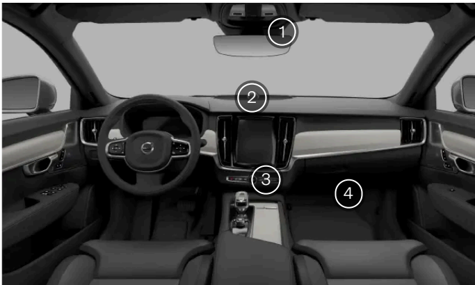
Los sensores de climatización interiores
