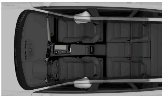
Airbags de colisión lateral para los ocupantes delanteros.
