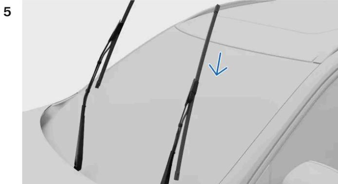
Compruebe que la escobilla del lado del conductor sea más larga que la del lado del acompañante. Deslice la escobilla en el brazo limpiaparabrisas. Asegúrese de que el pasador del brazo del limpiaparabrisas entra en el orificio de la escobilla. Introduzca la escobilla en el brazo del limpiaparabrisas hasta que escuche un clic.
