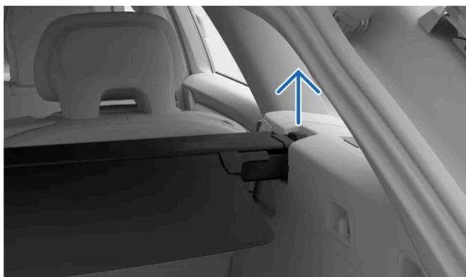
Saque completamente la cubierta de equipajes de las muescas en la parte trasera del maletero para retirarla.
