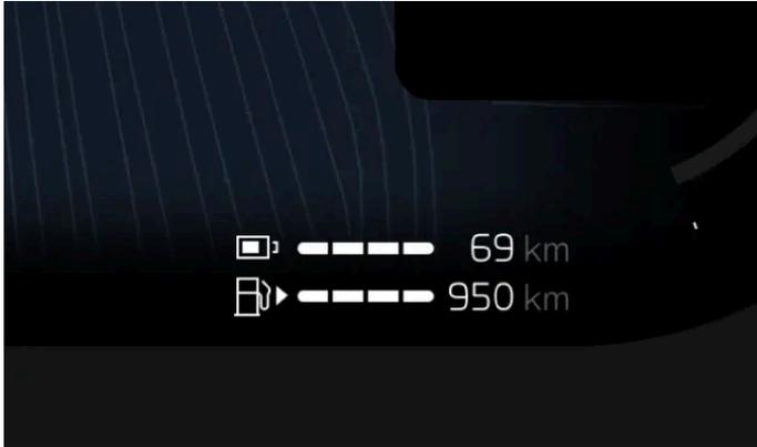
La autonomía está relacionada principalmente con la batería del automóvil, la cantidad de combustible restante en el depósito del automóvil y sus prácticas de conducción, pero las condiciones externas también pueden ser un factor. El nivel de batería y la autonomía prevista aparecen en la pantalla del conductor. La autonomía prevista se calcula según su patrón de conducción, tanto actual como histórico.
