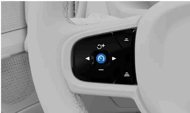
Cuando pueda hacerlo con seguridad, pulse el botón de Pilot Assist
