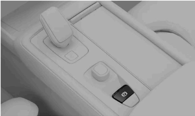
Accione manualmente el freno de estacionamiento tirando del interruptor del freno de estacionamiento.
