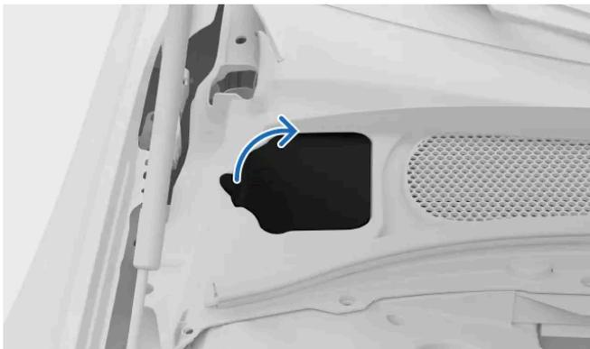
Abra la trampilla del panel en la esquina superior izquierda del compartimento del motor para acceder al recipiente del refrigerante.
