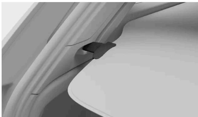
Levante y tire del extremo de la pantalla de la cubierta de equipajes por el asa para desbloquearla. Esto permite que la pantalla se retraiga.
