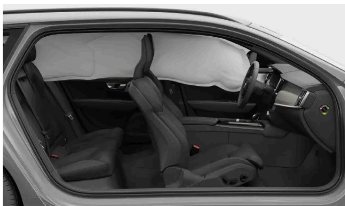
Cortina inflable desplegada en un lateral del automóvil.
