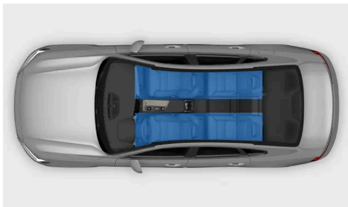
Zonas de climatización
