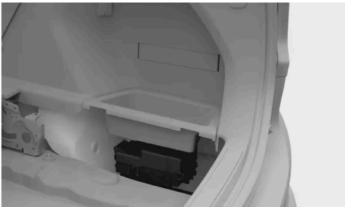
Ubicación de la caja de fusibles
