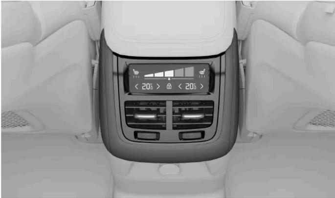
Controles de climatización en la consola del túnel
