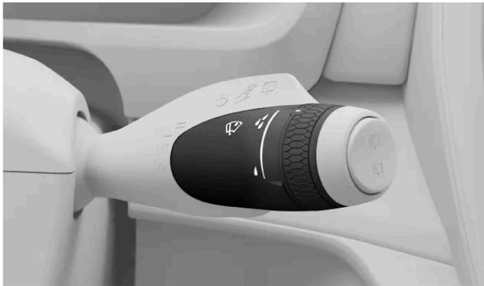
Los controles del limpiaparabrisas delantero están en la palanca derecha del volante.
