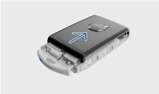
➤ La carcasa delantera se desacopla.
