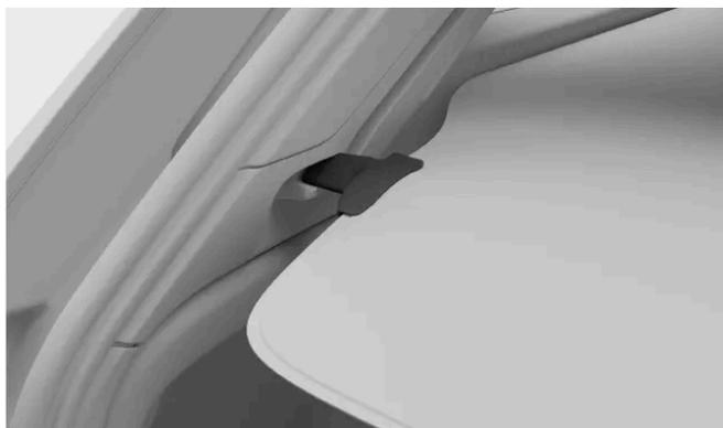
Levante y tire del extremo de la pantalla de la cubierta de equipajes por el asa para desbloquearla. Esto permite que la pantalla se retraiga.
