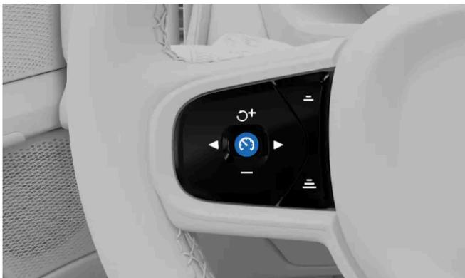
Cuando pueda hacerlo con seguridad, pulse el botón de Pilot Assist
