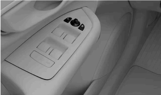
Controles para ajustar los retrovisores exteriores
