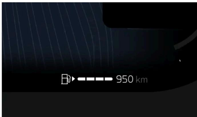
Su autonomía depende sobre todo de la cantidad de combustible restante en el depósito de su automóvil y sus prácticas de conducción, aunque las condiciones externas también pueden ser un factor. El medidor de combustible y la autonomía prevista aparecen en la pantalla del conductor.
