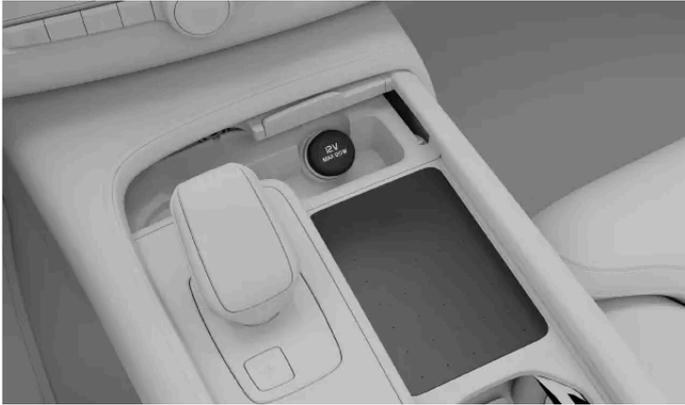
La toma de 12 V en la consola del túnel
