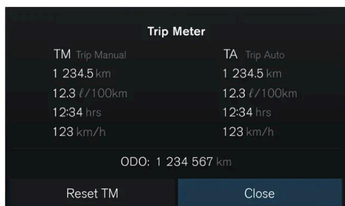
Su automóvil tiene cuentakilómetros parcial y cuentakilómetros. El cuentakilómetros parcial puede mostrar información sobre la distancia y el tiempo de conducción del automóvil, así como el consumo medio de combustible y la velocidad de conducción.
