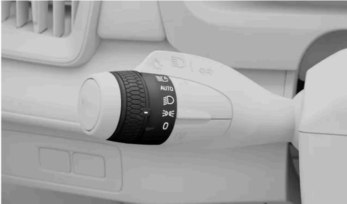
El símbolo de las luces de posición en el mando giratorio en la palanca izquierda
