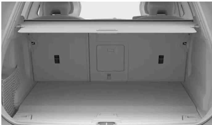
Las posiciones de los puntos de anclaje superiores de los asientos traseros se indican con el símbolo de la sujeción superior.
