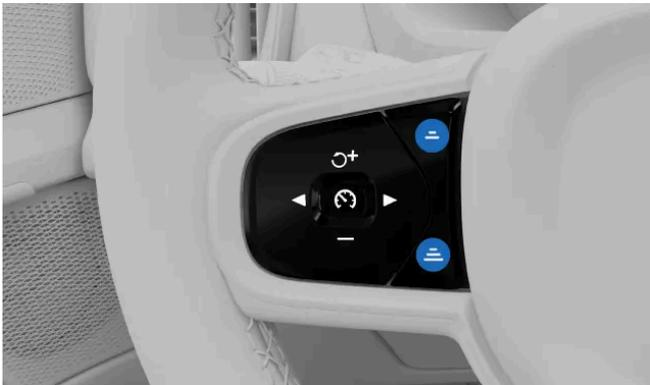
Ajuste el intervalo de tiempo a los vehículos que circulan por delante utilizando los botones del volante.
