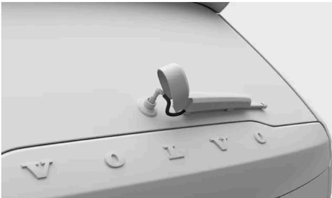
Localice la tapa de plástico en la que el brazo limpiaparabrisas está conectado al automóvil. Afloje primero el lado de la tapa más cercano a su posición y después el más alejado. Levante del todo la tapa de plástico. De este modo podrá acceder al conector de la manguera.
