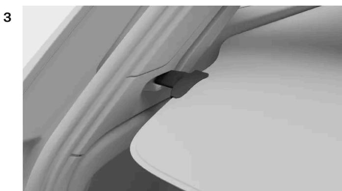
Guíe los extremos de la cubierta de equipajes hasta la posición de bloqueo en las ranuras.
