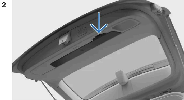
El triángulo de advertencia se encuentra en el interior de la compuerta del maletero. Tire de la manilla para abrirla.
