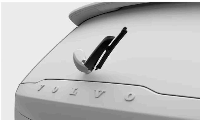
Agarre la parte central del brazo del limpiaparabrisas, elévelo y aléjelo del parabrisas trasero. Puede que detecte un poco de resistencia a medio camino, es la posición de bloqueo. Debe tirar del brazo y pasar de esa posición de bloqueo para que no vuelva a caer encima del parabrisas.
