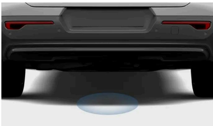
El sensor detecta el movimiento debajo del parachoques trasero. Cualquier movimiento detectado desbloquea el maletero.
