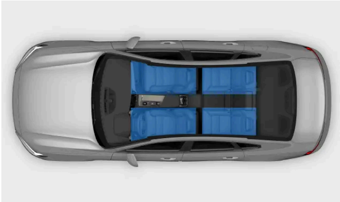
Zonas de climatización
