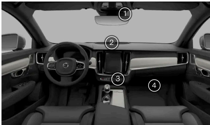
Los sensores de climatización interiores
