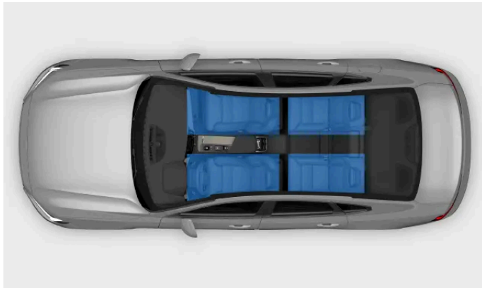
Zonas de climatización
