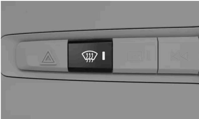
Botón de desempañado máximo en el panel de botones debajo de la pantalla central
