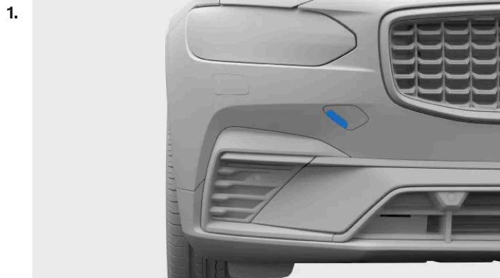
Cubierta de fijación de la anilla de remolque delantera
