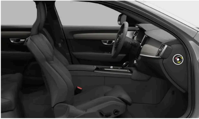
Posición del interruptor del airbag del acompañante
