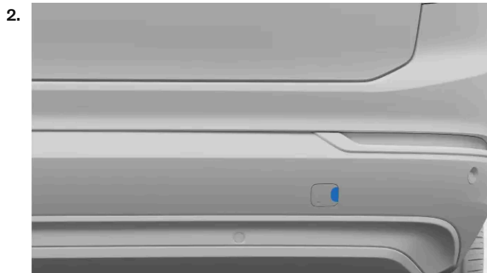
Cubierta de fijación de la anilla de remolque trasera
