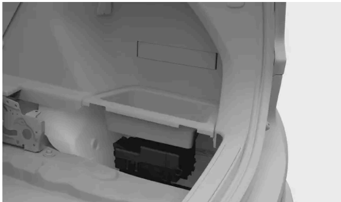
Ubicación de la caja de fusibles
