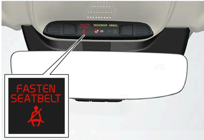
Aviso luminoso en la consola de techo.
