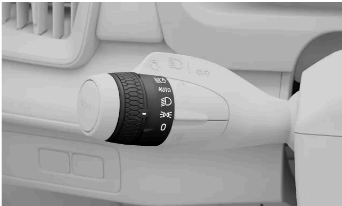
El símbolo de las luces de posición en el mando giratorio en la palanca izquierda
