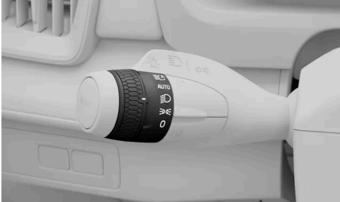
El símbolo de las luces de cruce en el mando giratorio en la palanca izquierda
