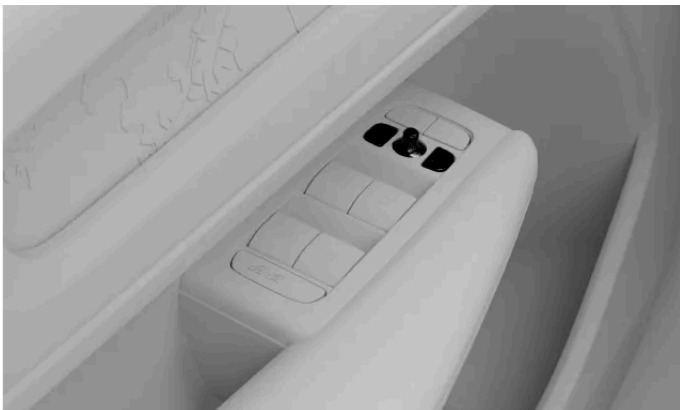
Controles para ajustar los retrovisores exteriores
