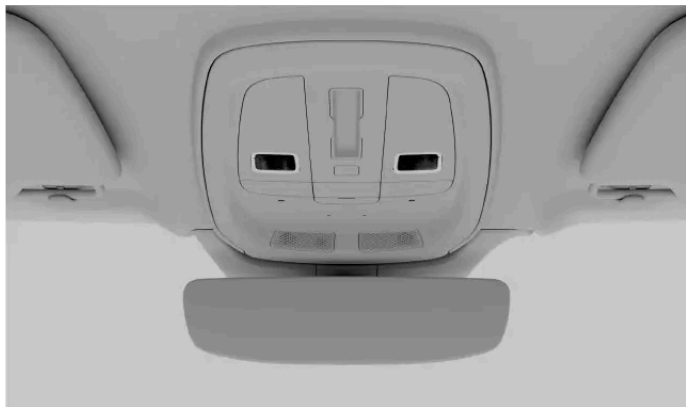
Las luces de lectura delanteras en la consola del techo
