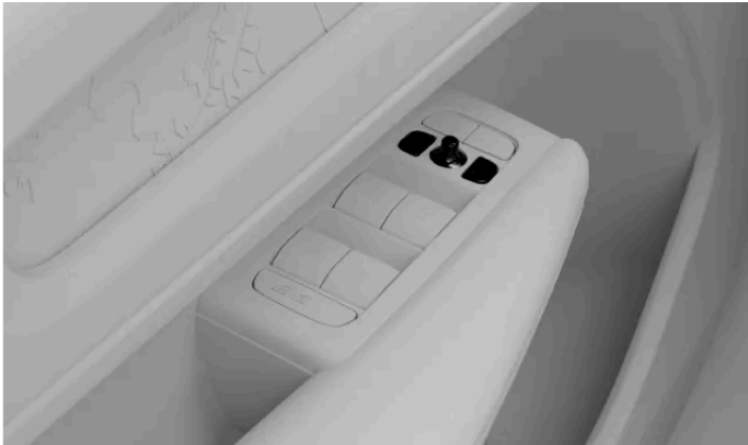
Controles para ajustar los retrovisores exteriores
