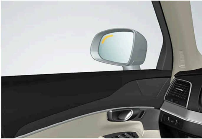
Ubicación del testigo de BLIS
