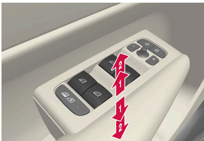
Accionamiento de los elevallunas eléctricos.
