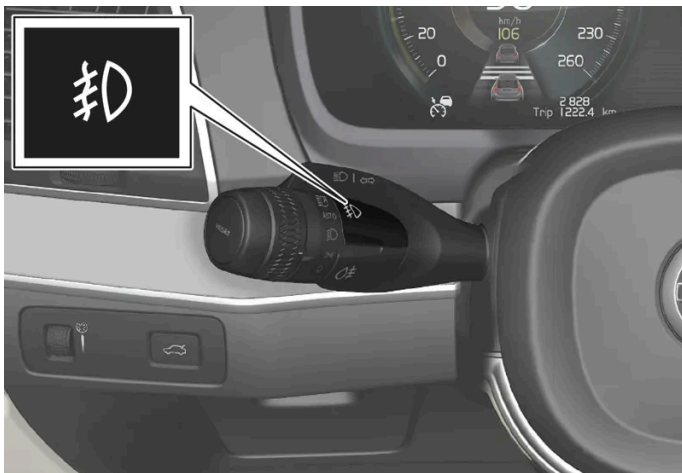
Botón para la luz antiniebla delantera.
