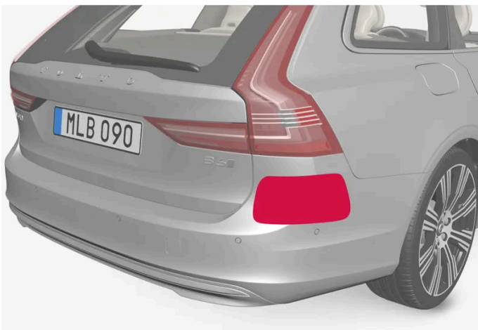
Ubicación de unidades de radar traseras
