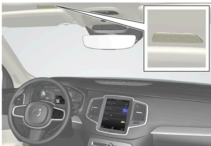
Micrófono del sistema de control por voz
