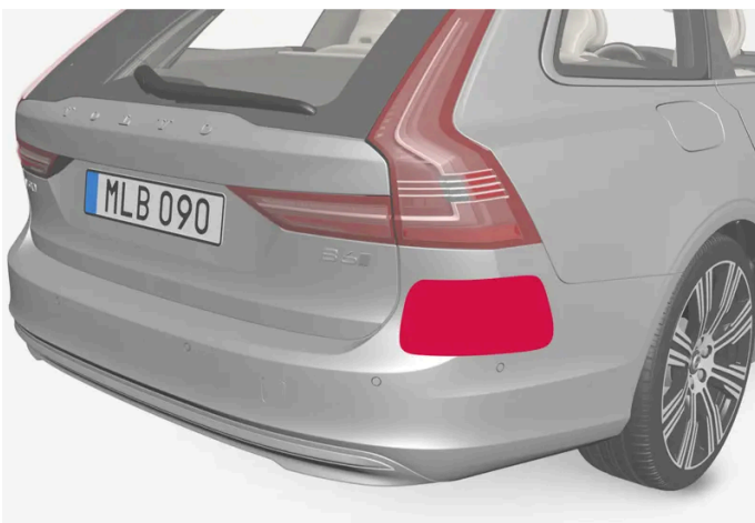
Ubicación de unidades de radar traseras
