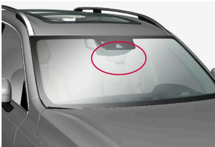
Ubicación de la unidad delantera de radar
