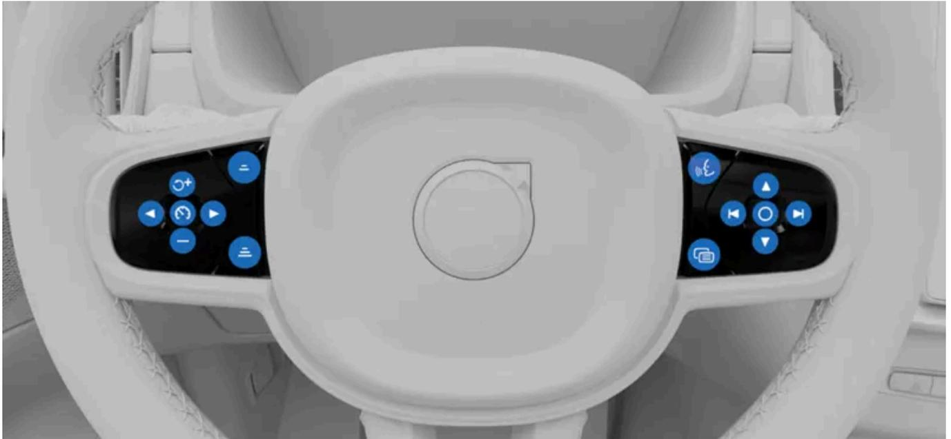
Los botones del lado izquierdo del volante controlan las funciones de apoyo a la conducción.
