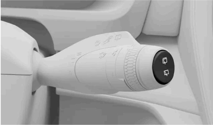
Los controles del limpiaparabrisas trasero están en la palanca derecha del volante.
