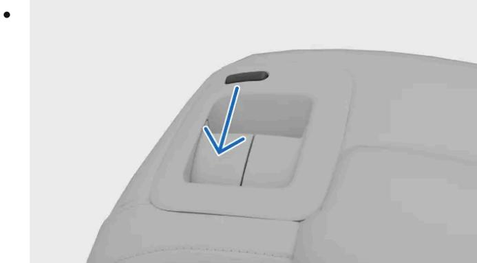
Tire del tirador del respaldo del asiento. Un indicador rojo cerca del bloqueo del respaldo indica que este ya no está bloqueado.
