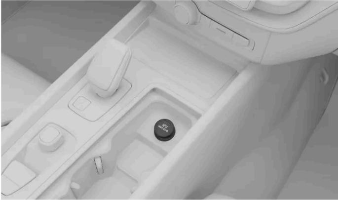
La toma eléctrica de 12 V en la consola del túnel
