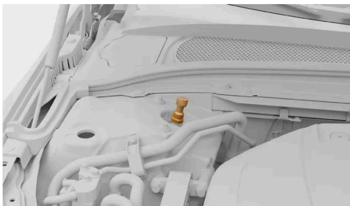
En el caso de las ruedas delanteras, las perillas de ajuste de la suspensión se encuentran bajo el capó.
