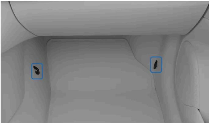
Los puntos de anclaje de sujeción inferior del asiento del acompañante delantero están situados a ambos lados de la zona para los pies del asiento.
