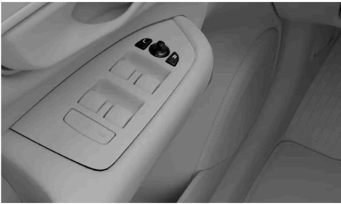
Controles para ajustar los retrovisores exteriores
