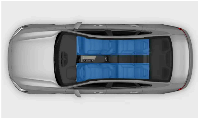
Zonas de climatización
