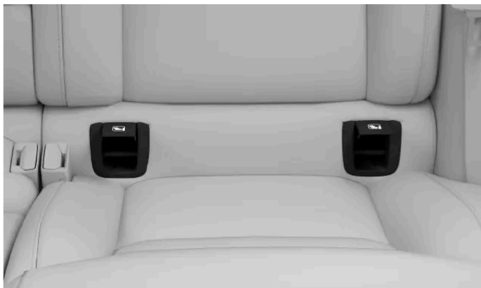
Posición de los puntos de anclaje ISOFIX de los asientos traseros exteriores
