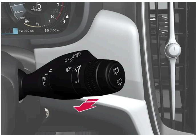
Función de lavado, palanca derecha del volante.
