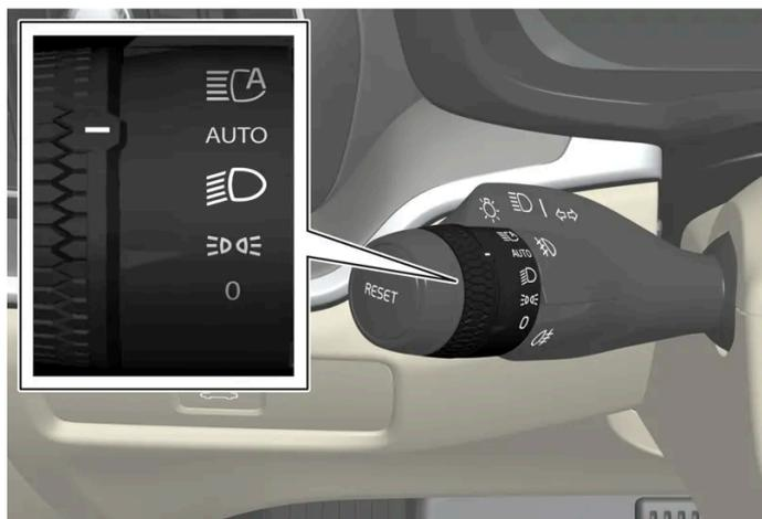
Mando giratorio de palanca izquierda del volante.
