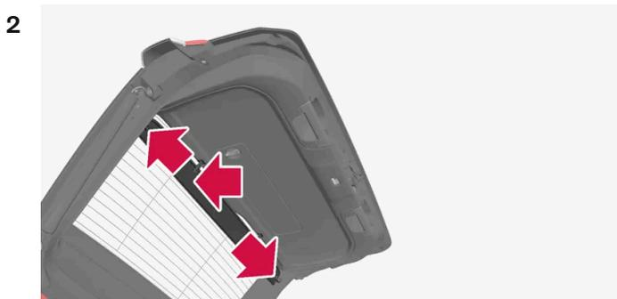
Suelte el panel con cuidado de la fijación de uno de los lados del portón trasero y a continuación, de la fijación del otro lado. Si es necesario, apriete un poco el panel para hacerlo más flexible y facilitar así el desmontaje.
