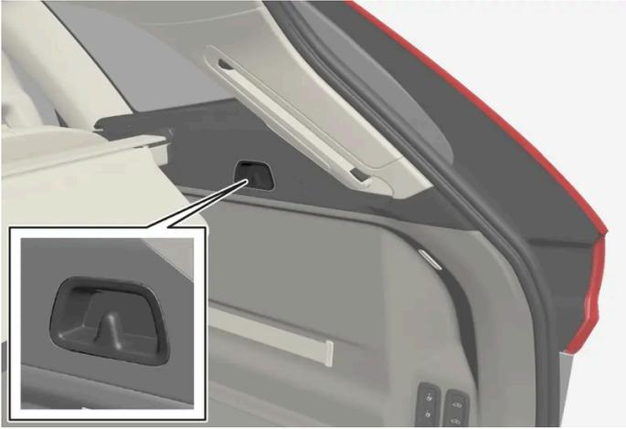
Hay un gancho para bolsas de la compra en los paneles de ambos lados del compartimento de carga.
