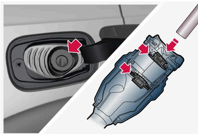
Antes de empezar a repostar, es importante introducir la boquilla del surtidor a través de los dos cierres del tubo de llenado.
