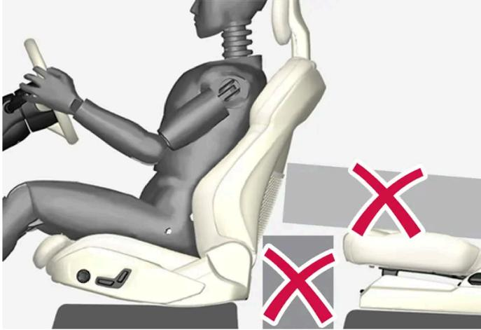
No coloque en el suelo detrás o debajo de los asientos delanteros o en el asiento trasero objetos que puedan impedir el debido funcionamiento del sistema WHIPS.
