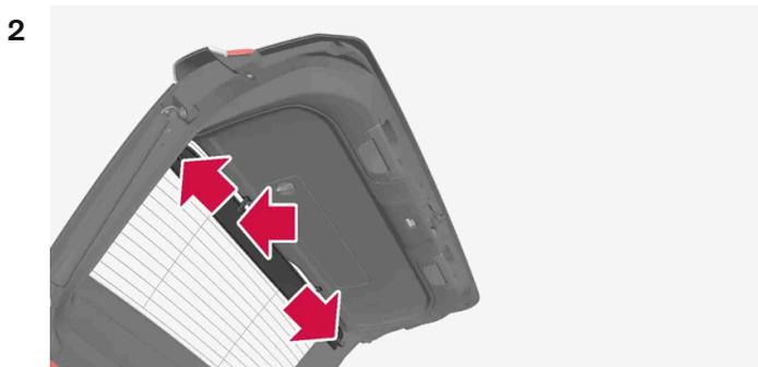
Suelte el panel con cuidado de la fijación de uno de los lados del portón trasero y a continuación, de la fijación del otro lado. Si es necesario, apriete un poco el panel para hacerlo más flexible y facilitar así el desmontaje.
