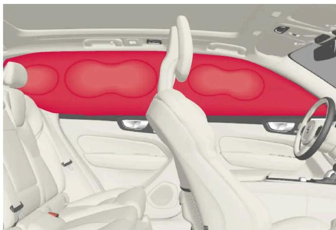
La cortina inflable va instalada sobre ambos laterales del techo interior, ayudando a proteger al conductor y a los ocupantes situados en las plazas exteriores del vehículo. Los paneles están identificados con IC AIRBAG.
