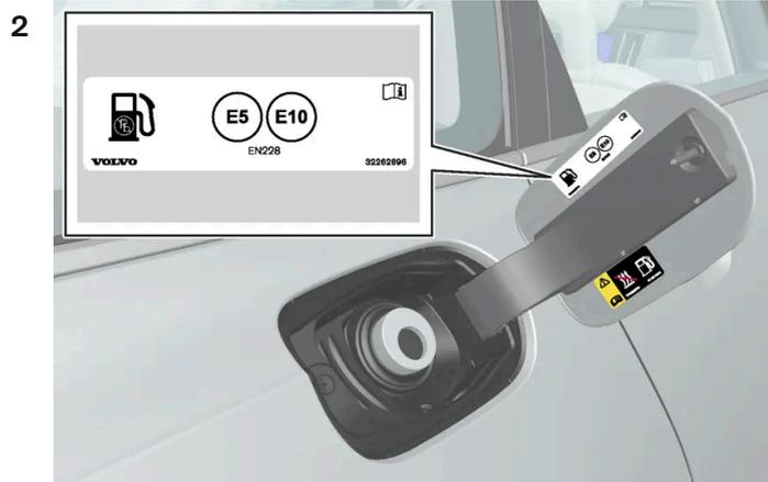
Seleccione el combustible homologado para su uso con el vehículo conforme al identificador<sup>[1]</sup> del interior de la portezuela del depósito. Consulte la información relativa a los combustibles homologados y el identificador en el apartado "Gasolina".
