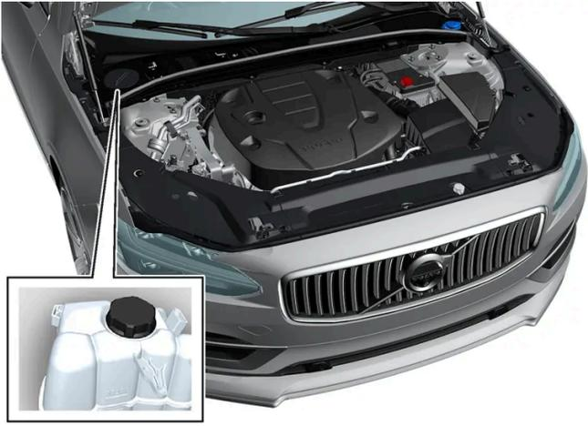
Depósito de expansión del sistema de refrigeración, vehículo con el volante a la izquierda.
