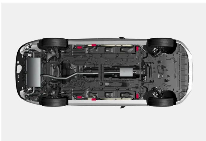
El vehículo cuenta con puntos de elevación exteriores para alzamientos más pequeños y puntos de elevación interiores para izamientos mayores, mediante, por ejemplo, gatos de taller o brazos de elevación.
