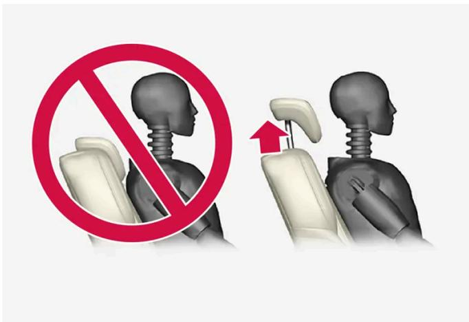
El reposacabezas de la plaza central debe ajustarse en función de la altura del pasajero para que, a ser posible, cubra toda la parte trasera de la cabeza. Suba el reposacabezas manualmente según sea necesario.
