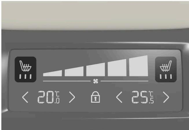
Indicación de calefacción del asiento y mandos en el panel de climatización de la consola del túnel.
