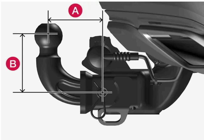
La bola de remolque debe compatibilizar bien con las limitaciones geométricas del enganche para remolque, tanto en distancia de separación **A** como en altura **B**. Las limitaciones geométricas aparecen descritas en la placa explicativa situada en el enganche.
