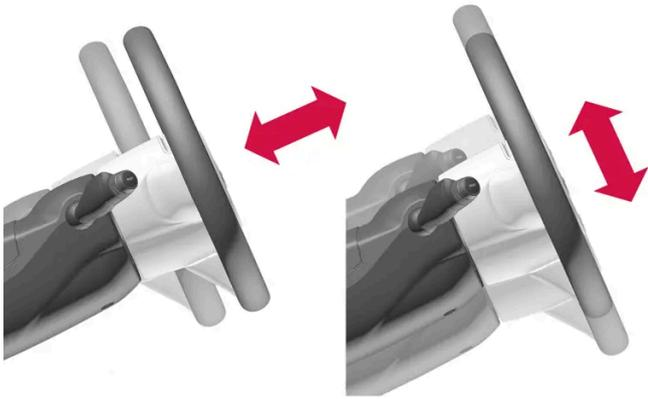
El volante puede ajustarse en profundidad y en altura.
