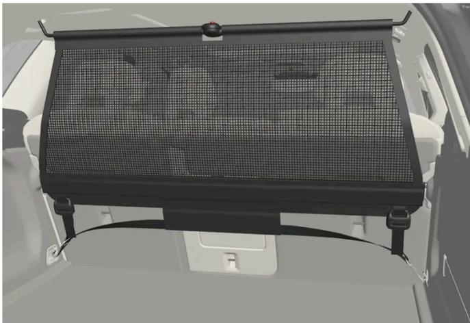
Por razones de seguridad, la red de protección debe fijarse y asegurarse siempre según la descripción siguiente.
