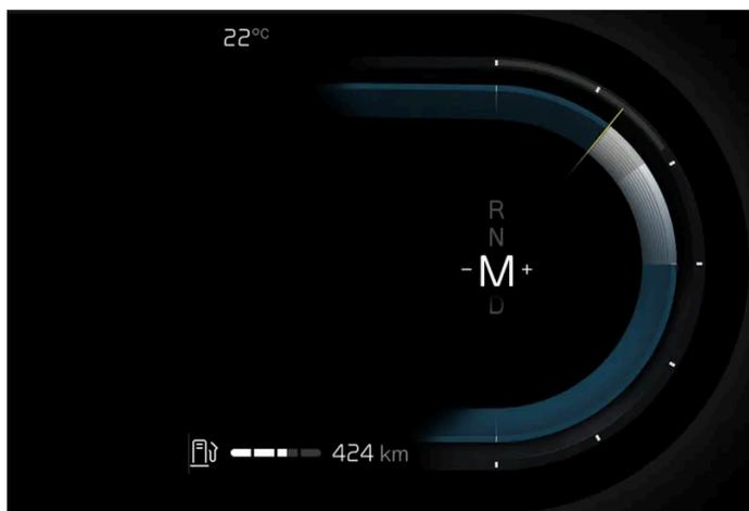
Con la posición M es posible cambiar de marcha manualmente. El motor frena el automóvil cuando se suelta el pedal del acelerador.
