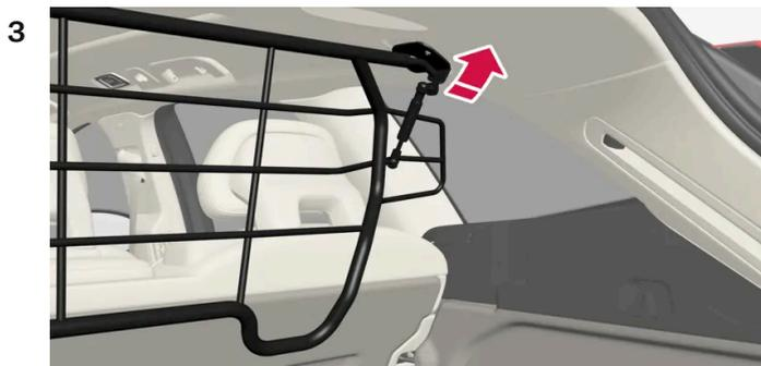
Coloque las fijaciones de la rejilla de protección en los anclajes del techo.
