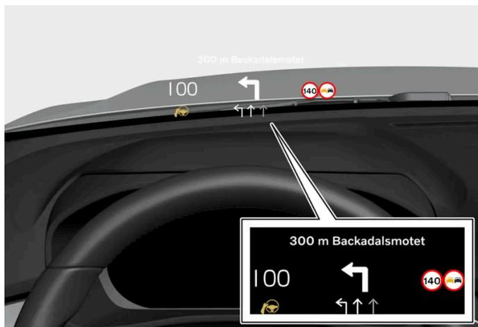
La pantalla de visualización frontal muestra información seleccionada que el conductor debe gestionar tan pronto como sea posible. Puede tratarse, por ejemplo, de advertencias de tráfico, información sobre la velocidad y navegación. En la pantalla de visualización frontal se muestra también información sobre señales de tráfico y llamadas telefónicas. Esta pantalla se controla con el teclado derecho del volante y desde la pantalla central.
