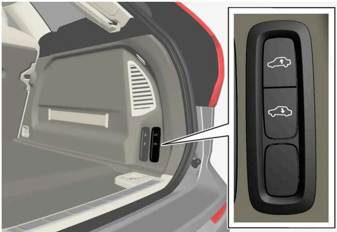
Utilice los botones situados en el compartimento de carga para regular la altura de la sección trasera y facilitar la carga y la descarga o el enganche y desenganche de un remolque.
