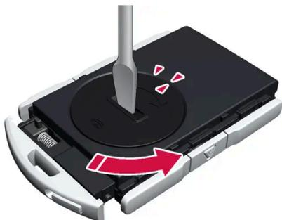
Gire la tapa de la pila a la izquierda hasta la posición OPEN. Puede usar, por ejemplo, un destornillador o una moneda.
