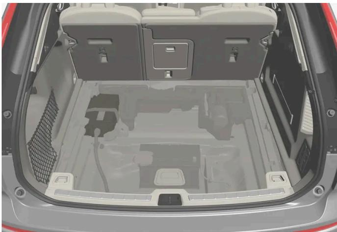
Los automóviles del tipo híbrido suave tienen una batería de apoyo de 48 V debajo del compartimento de carga. La batería solo puede manipularla un taller autorizado.
