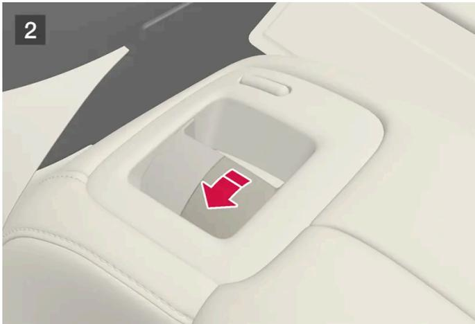
En los vehículos sin abatimiento eléctrico, los reposacabezas laterales se abaten manualmente con el mando interior situado en la parte superior del asiento. Vea la figura **2**.
