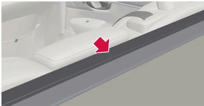
Asegúrese de orientar hacia abajo el tablero de revestimiento delantero, por detrás de los respaldos, antes de colocar la caja.
