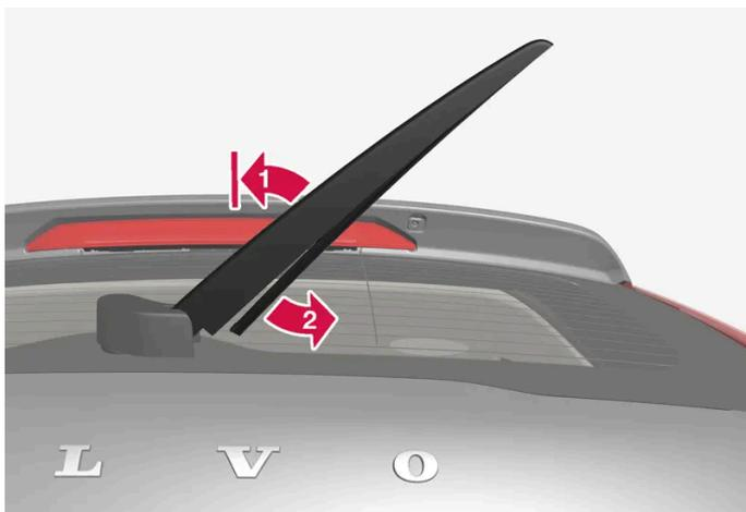
Levante el brazo de la luna y tire de la parte inferior de la escobilla hacia la derecha.
