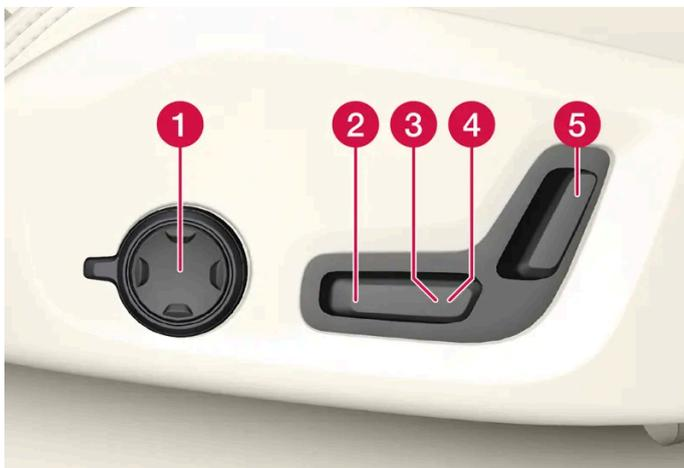
La imagen muestra los mandos de un automóvil con apoyo lumbar de cuatro direcciones \*. Los automóviles con apoyo lumbar de dos direcciones \* no disponen de control multifuncional giratorio.
