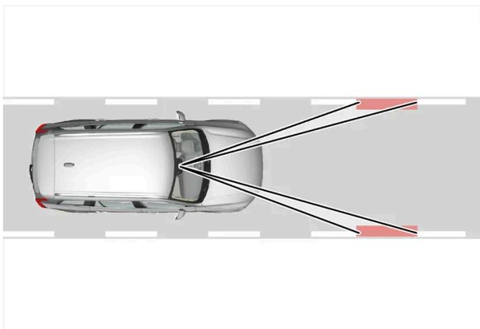
El sistema Driver Alert lee el emplazamiento del automóvil dentro del carril.
