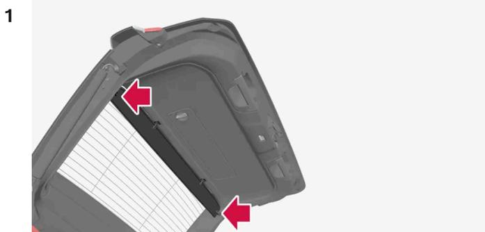
Gire el panel en la dirección correcta con la parte de los tornillos hacia abajo e introduzca el pasador en la fijación de uno de los lados del portón trasero.
