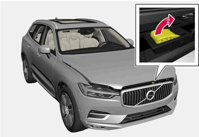
➡ Realice un barrido de izquierda a derecha en la abertura situada bajo el capó, desplace arriba y a un lado para soltar el fiador y levante el capó.
