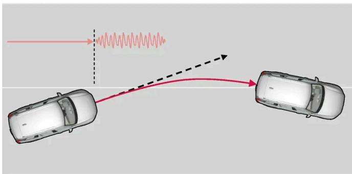
El sistema de permanencia en el carril avisa con vibraciones en el volante.
