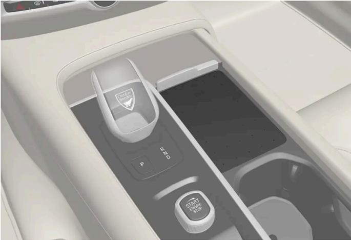
Cargador inalámbrico en la consola del túnel.
