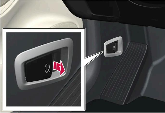
➡ Tire de la palanca situada al lado de los pedales para liberar el capó de su posición de bloqueo.
