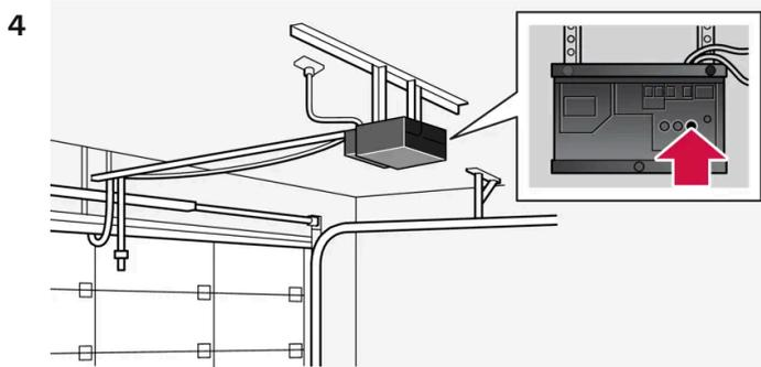
Busque el botón de aprendizaje <sup>[2]</sup> en el receptor de, por ejemplo, la puerta del garaje. Suele estar situado cerca de la sujeción de la antena en el receptor.
