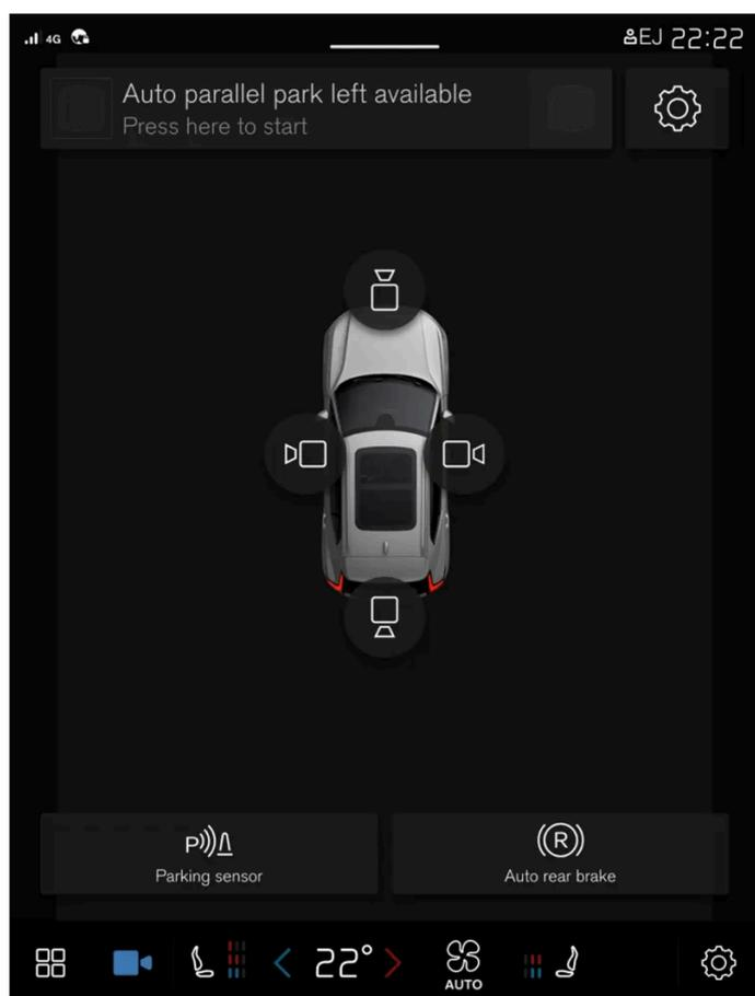
La vista de cámara muestra las cámaras del aparcamiento asistido (PAC<sup>[1]</sup>) donde aparece una vista combinada de 360° y una vista independiente de cada una de las cuatro cámaras: trasera, delantera, izquierda o derecha.
