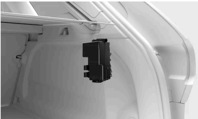
Ubicación de la caja de fusibles
