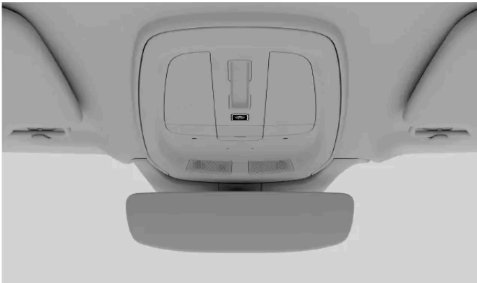
El botón de apagado automático de las luces en la consola del techo
