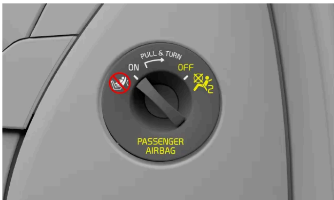
Airbags activados. Utilice siempre esta posición cuando haya un acompañante, niño o adulto, sentado y orientado en el sentido de la marcha.
