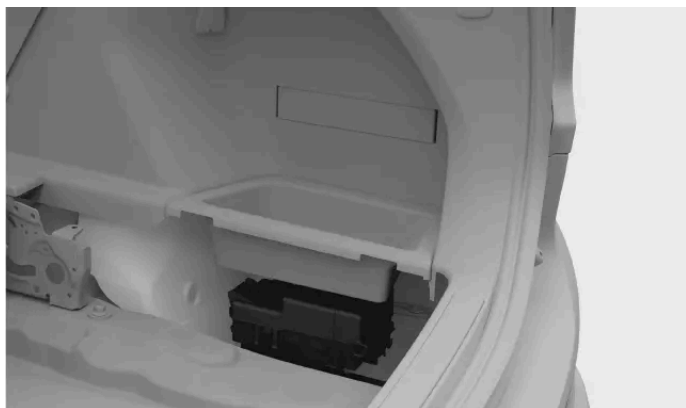
Ubicación de la caja de fusibles
