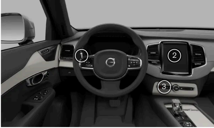
Posiciones de controles de luces exteriores
