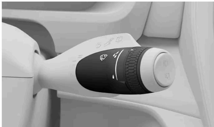
Los controles del limpiaparabrisas delantero están en la palanca derecha del volante.
