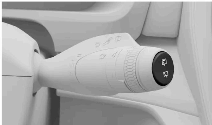
Los controles del limpiaparabrisas trasero están en la palanca derecha del volante.
