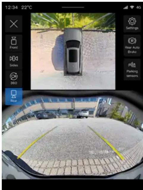
La vista de aparcamiento puede mostrar dos vistas al mismo tiempo. La imagen muestra un ejemplo de su aspecto tras seleccionar la vista de cámara trasera, que se muestra en la mitad inferior de la pantalla central. La mitad superior de la pantalla muestra una visión general del entorno de su automóvil.
