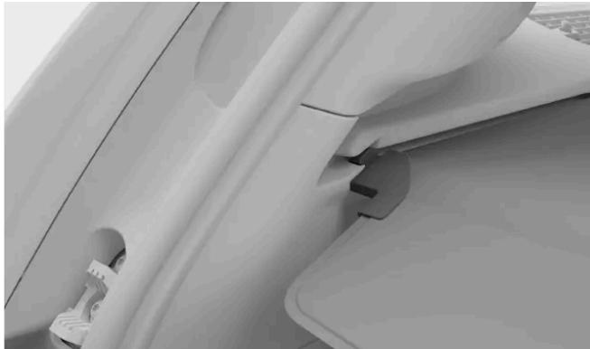
Levante y tire del extremo de la pantalla de la cubierta de equipajes por el asa para desbloquearla.
