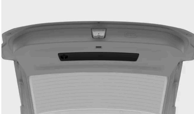
El triángulo de advertencia se encuentra en el interior de la compuerta del maletero. Abra el compartimento girando la manilla hasta que quede en posición vertical y luego tirando de ella.
