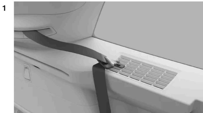
Aparte el cinturón de seguridad de la tercera fila cuando utilice la cubierta de equipajes. Retraiga el cinturón de seguridad y cuélguelo por la hebilla.
