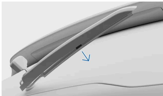
Tire de la escobilla hacia abajo hasta que se afloje y se suelte del brazo limpiaparabrisas.
