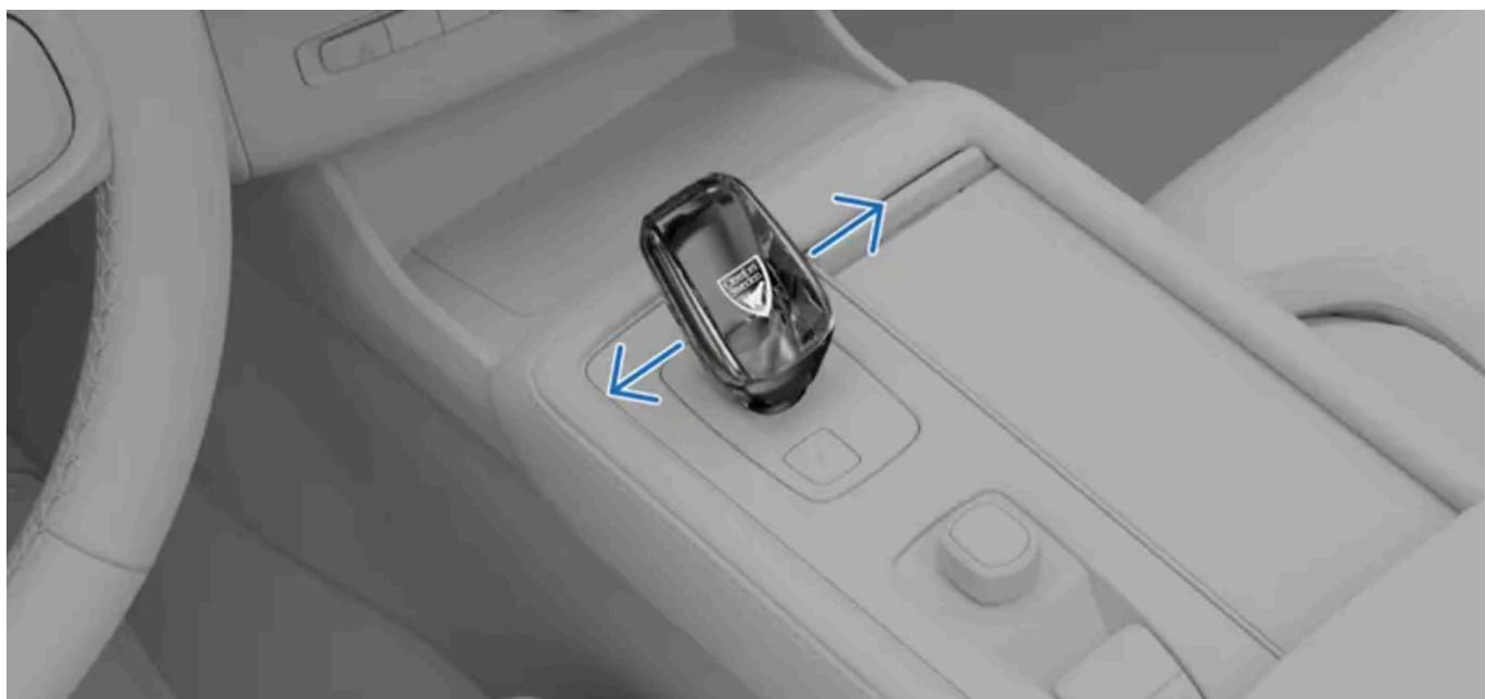
Después de seleccionar la marcha M, puede cambiar manualmente de marcha moviendo el selector de marcha hacia la izquierda o hacia la derecha.
