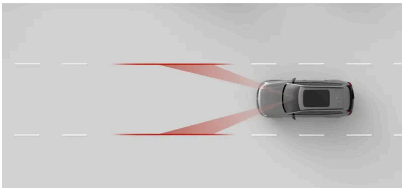
Cuando la asistencia de mantenimiento en el carril está activada, el automóvil puede alertarle si está a punto de desviarse de su carril y puede pedirle que conduzca con atención. También puede realizar intervenciones en la dirección. La asistencia para el mantenimiento en el carril utiliza la cámara orientada hacia delante del automóvil para identificar las líneas de la carretera y su posición en el carril.
