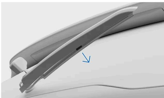
Tire de la escobilla hacia abajo hasta que se afloje y se suelte del brazo limpiaparabrisas.
