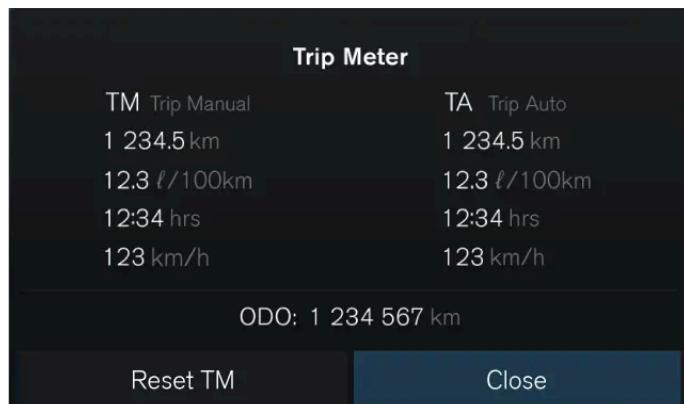
Su automóvil tiene cuentakilómetros parcial y cuentakilómetros. El cuentakilómetros parcial puede mostrar información sobre la distancia y el tiempo de conducción del automóvil, así como el consumo medio de combustible y la velocidad de conducción.
