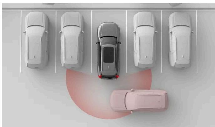
El automóvil puede detectar tráfico en sentido perpendicular detrás, por ejemplo al dar marcha atrás para salir de un aparcamiento. Su función es permitirle bajar la velocidad o frenar si es necesario.
