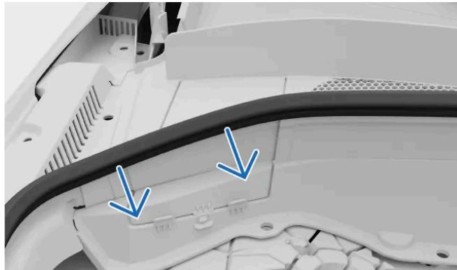
El recipiente del refrigerante se encuentra en la esquina superior izquierda del compartimento del motor, debajo de la trampilla de un panel. Tire de la junta de goma hacia el compartimento del motor para acceder a la trampilla.
