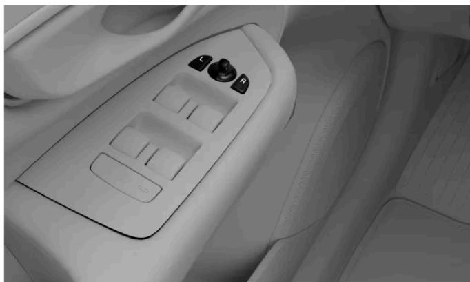
Controles para ajustar los retrovisores exteriores
