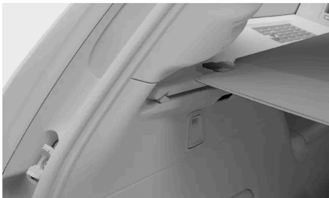
Deslice los extremos de la pantalla de la cubierta de equipajes en las ranuras superiores de los paneles laterales.
