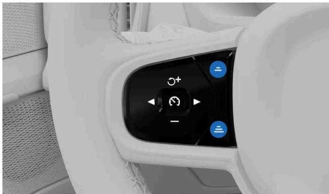
Ajuste el intervalo de tiempo a los vehículos que circulan por delante utilizando los botones del volante.
