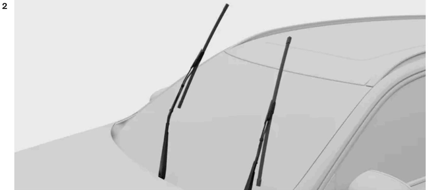
Pliegue los limpiaparabrisas hacia arriba y sepárelos del parabrisas.
