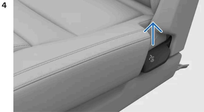
Tire del tirador situado en un lado del asiento hacia arriba para desbloquear el respaldo.
