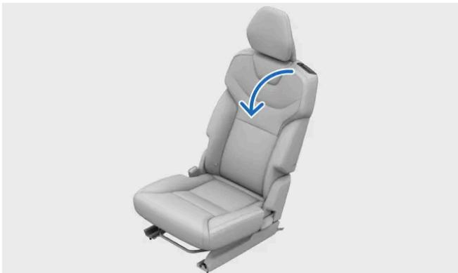
Tire del tirador situado en la parte superior del respaldo del asiento exterior.
