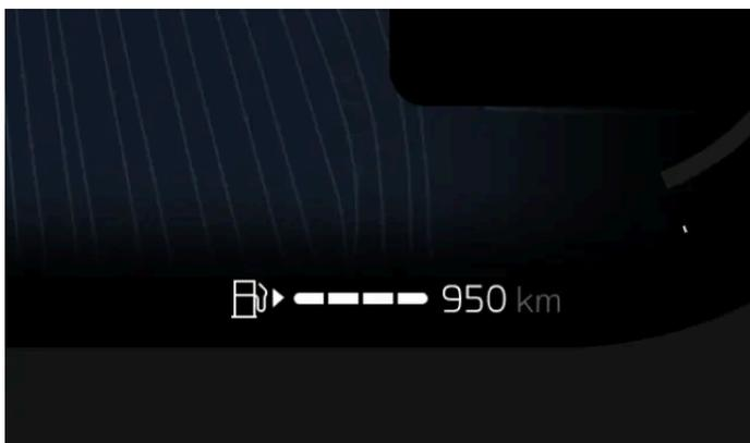
Su autonomía depende sobre todo de la cantidad de combustible restante en el depósito de su automóvil y sus prácticas de conducción, aunque las condiciones externas también pueden ser un factor. El medidor de combustible y la autonomía prevista aparecen en la pantalla del conductor.
