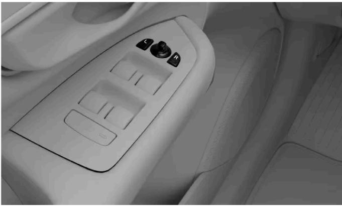
Controles para ajustar los retrovisores exteriores
