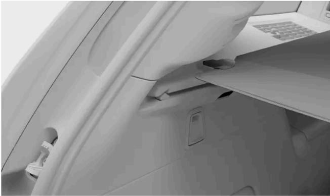
Levante los extremos de la pantalla de la cubierta de equipajes por la zona curvada. Agarre el asa y saque la pantalla de la cubierta de equipajes de las ranuras superiores. De este modo, la pantalla se recoge automáticamente.
