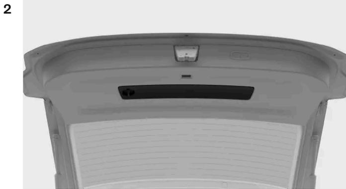
El triángulo de advertencia se encuentra en el interior de la compuerta del maletero. Abra el compartimento girando la manilla hasta que quede en posición vertical y luego tirando de ella.
