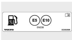
En los automóviles con motor de gasolina se puede utilizar gasolina con los siguientes identificadores:
