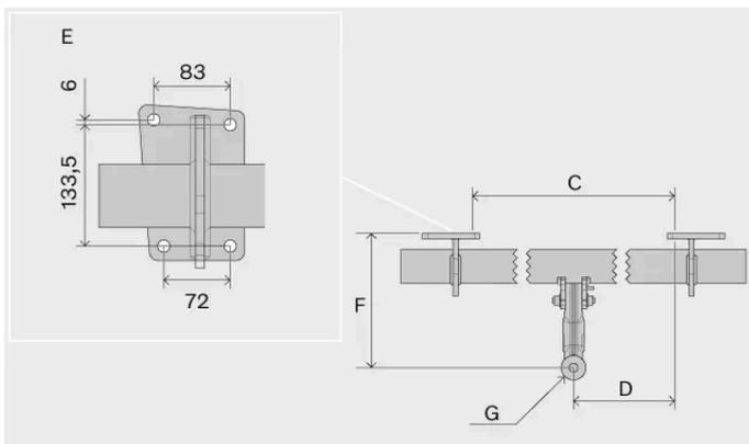
Dimensiones, puntos de fijación en mm (pulgadas)
