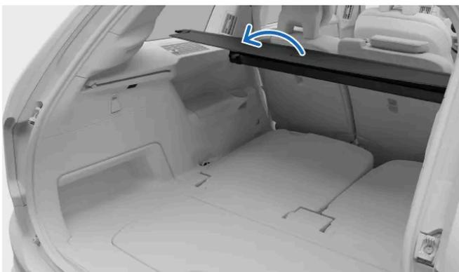
Tire del asa de la pantalla de la cubierta de equipajes por encima de los paneles laterales del maletero.
