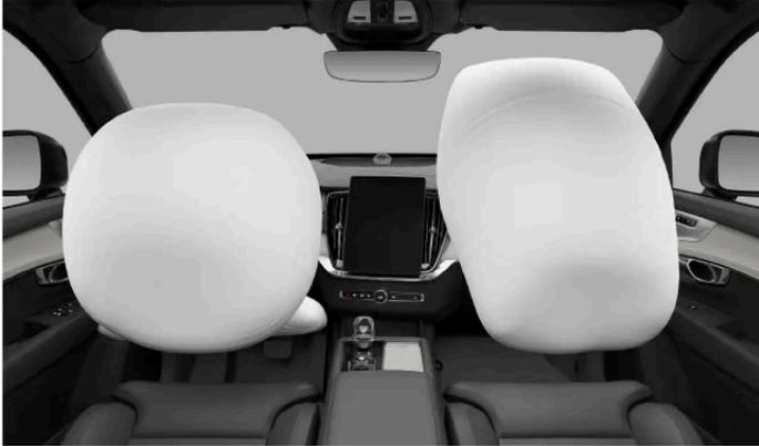
El lado de conducción tiene dos airbags delanteros. El airbag superior está dentro del volante y el airbag de rodilla está detrás de un panel debajo del volante.
