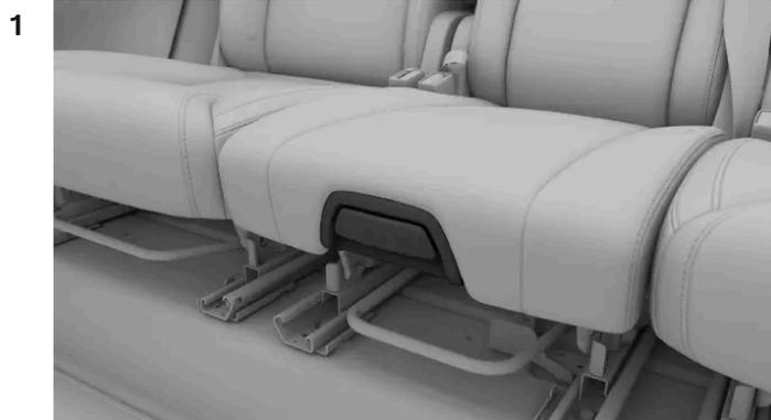
Tire del tirador de la parte delantera del cojín del asiento para desbloquearlo.
