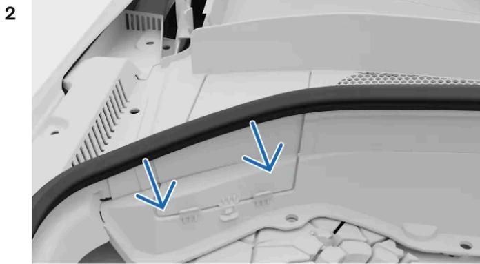
El recipiente del refrigerante se encuentra en la esquina superior izquierda del compartimento del motor, debajo de la trampilla de un panel. Tire de la junta de goma hacia el compartimento del motor para acceder a la trampilla.
