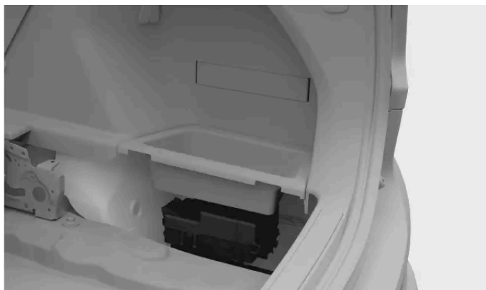
Ubicación de la caja de fusibles
