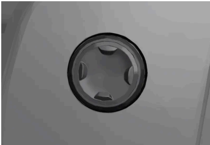
Nelisuuntapainike, sijoitettu istuimen istuinosaan sivulle.
