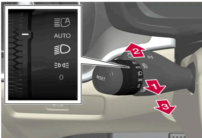
Ohjauspylvään vipu kiertorengaalla.
