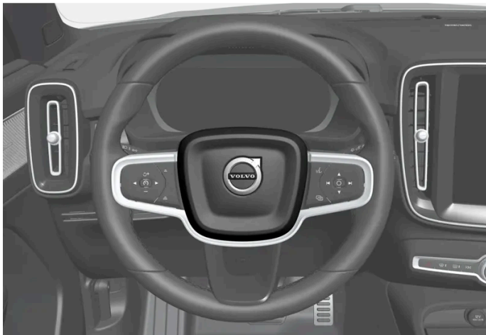
Äänitorven kytkin on sijoitettu ohjauspyörän keskiöön.
