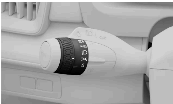
Seisontavalojen symboli vasemmanpuoleisen vivun kiertorengaassa.
