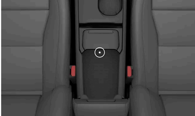
Varalukijan sijainti tunnelikonsolin säilytyslokerossa
