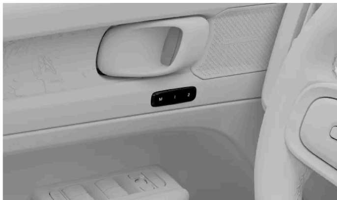
Istuimen esiasetuspainikkeiden sijainti
